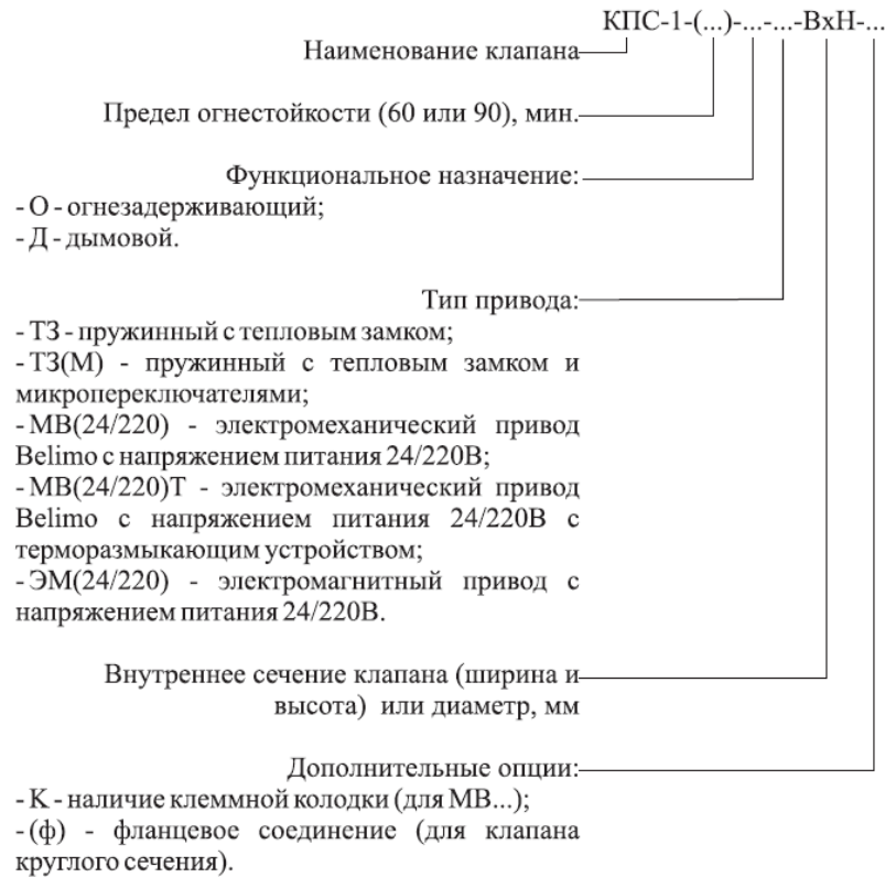
Рис. 18. Структура обозначения клапанов серии КПС-1 производства ООО «ВКТехнология» [10]
