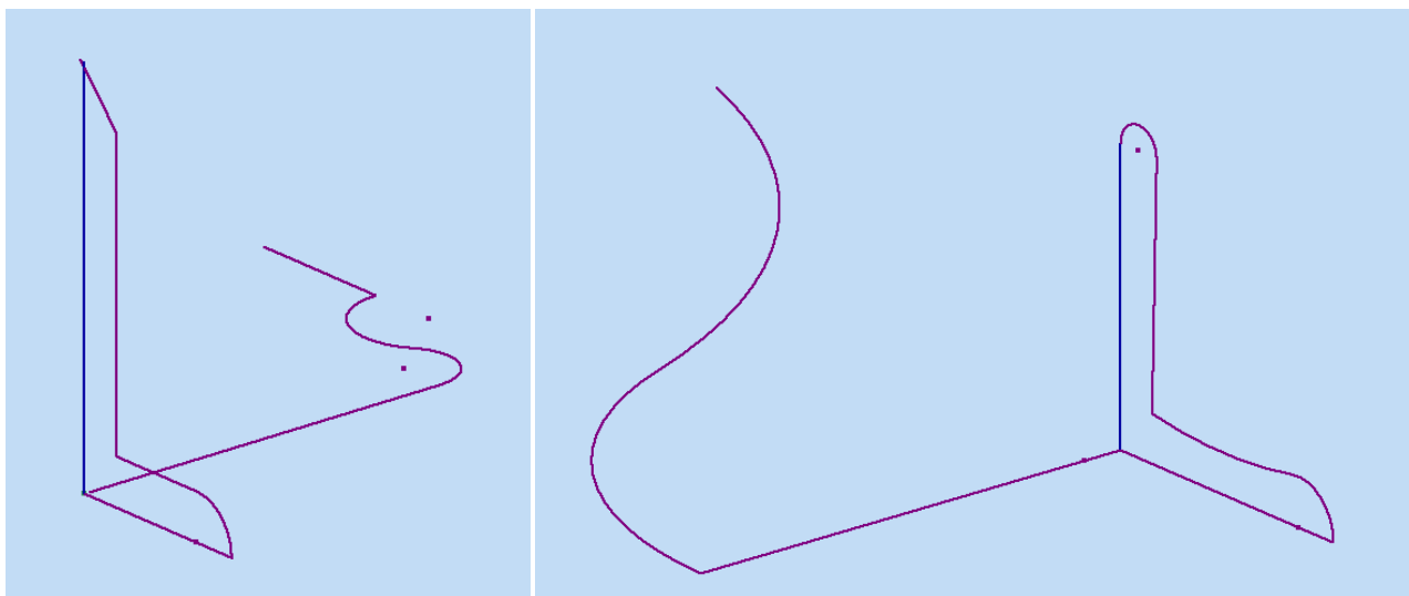
Рис. 2.42 Неправильный и правильный эскиз для сдвига, выполненный в плоскости XZ.
