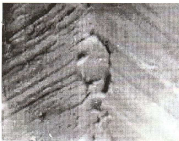
Рис. 3.28. Микроструктура кадмия после испытаний на усталость при 20 °С; ( \times 10\ 000 ); \sigma = 36 МПа; N = 2,6 \cdot 10^3 циклов; \omega = 0,033 Гц. Деформация изгиба вращающегося образца
