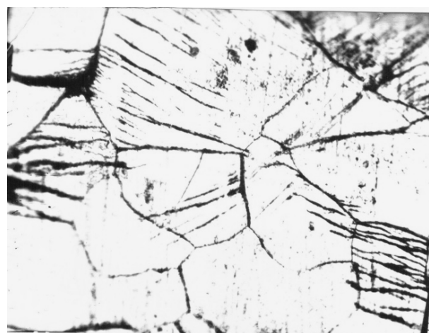
Рис. 3.30. Микроструктура титана ВТ-1-00 после испытаний на усталость при 20 °С; ( \times 600 ); \sigma = 160,1 МПа; N = 9,55 \cdot 10^4 циклов; \omega = 46,7 Гц. Деформация изгиба вращающегося образца
