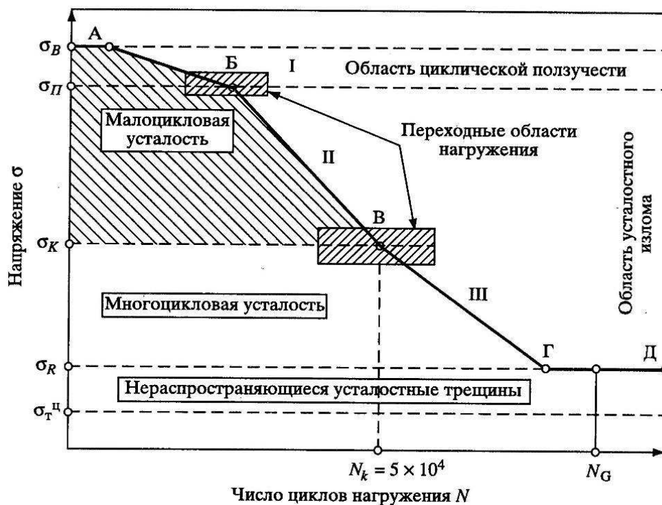
Рис. 1.2. Полная кривая усталости
