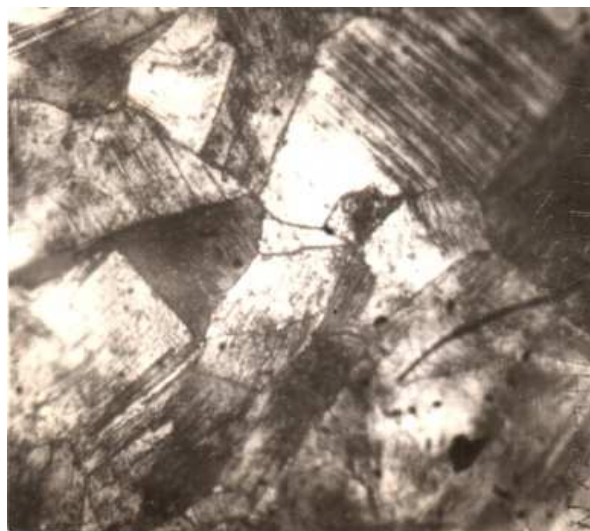
Рис. 3.5: a – кривые усталости титана ВТ-1-00 (1,2,3) и меди (4,5) при t = 20^\circ\text{C} . Частота циклов 46,7 (1,4), 100 (2,5) 233,3 (3) Гц; б, в – микроструктура меди после испытаний на усталость при 20^\circ\text{C} ; a – (x450) и б – (x500); \sigma = 150 и 76 МПа; N = 10^4 и 1,7 \cdot 10^5 циклов; \omega = 46,7 и 100 Гц. Деформация изгиба вращающегося образца
