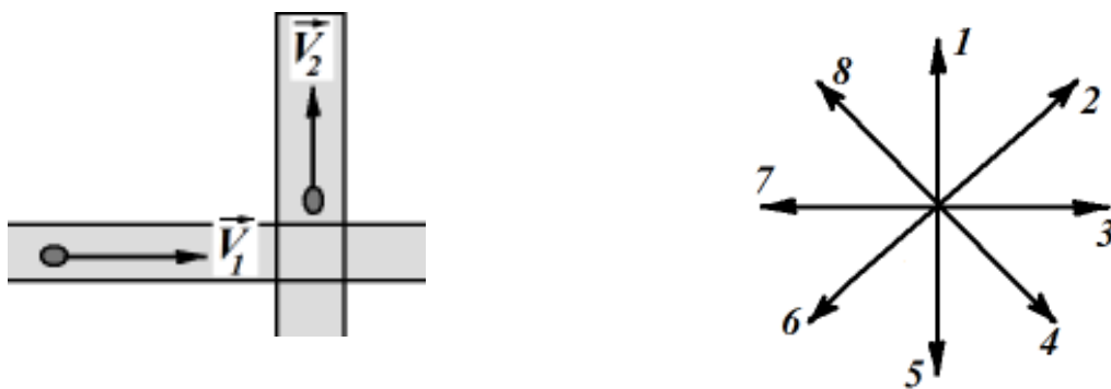
Рис. 28. Чертёж к задаче 11. Схематическое представление движения двух автомобилей по взаимно перпендикулярным направлениям (слева) и предположительные направления векторов их относительных скоростей (справа)
