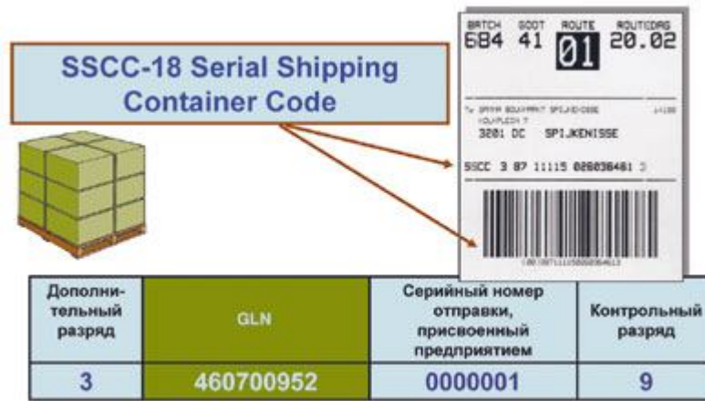
Рис. 20. Серийный код транспортной упаковки SSCC-18
