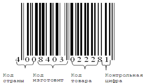
Рис. 5. Код EAN-13, внешний вид и структура
