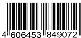
Рис. 1. Одномерный штриховой код
