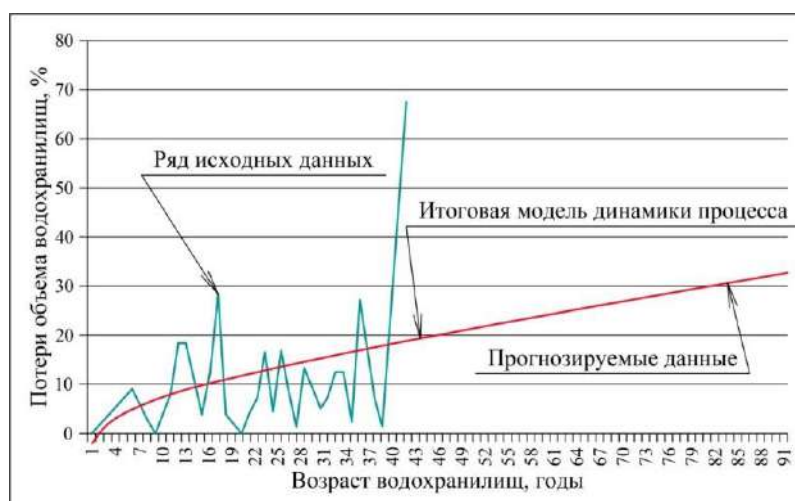
Рис. 17.11 Синтезированная модель процесса потери объема Водохранилищ мира в зависимости от возраста [189]
