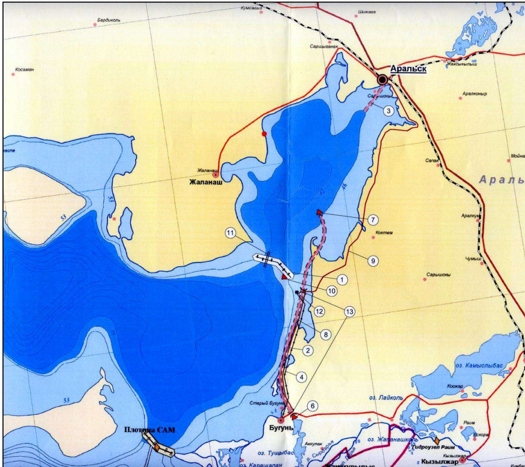
Рис. 30.7. План водохранилищ Коккаральского и Сарышыганак в северной части Аральского моря по проекту института Казгипроводхоз: плотина САМ – существующая Коккаральская плотина; 1 – проектируемая плотина Сарышыганак; 2 – водопроводный канал от р. Сырдарьи в водохранилище Сарышыганак; 3 – судоходный канал к пристани г. Аральска; 4 – электроснабжение; 5 – водозабор из реки; 6 – сооружение Тущибас; 7 – сбросное сооружение; 8 – эксплуатационная дорога вдоль канала; 9 – дорога к г. Аральску; 10 – водовыпуск в плотине; 11 – судоходный шлюз; 12 – поселок службы эксплуатации; 13 – автодорожный мост; 14 – граница затопления при НПУ = 52 м БС [325]
