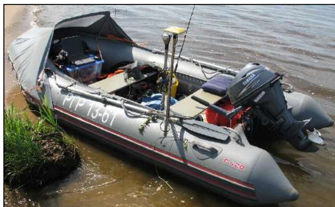
Рис. 17.3. Маломерное судно РГР 13-61 с эхолотным промерным комплексом ННГАСУ [575]
