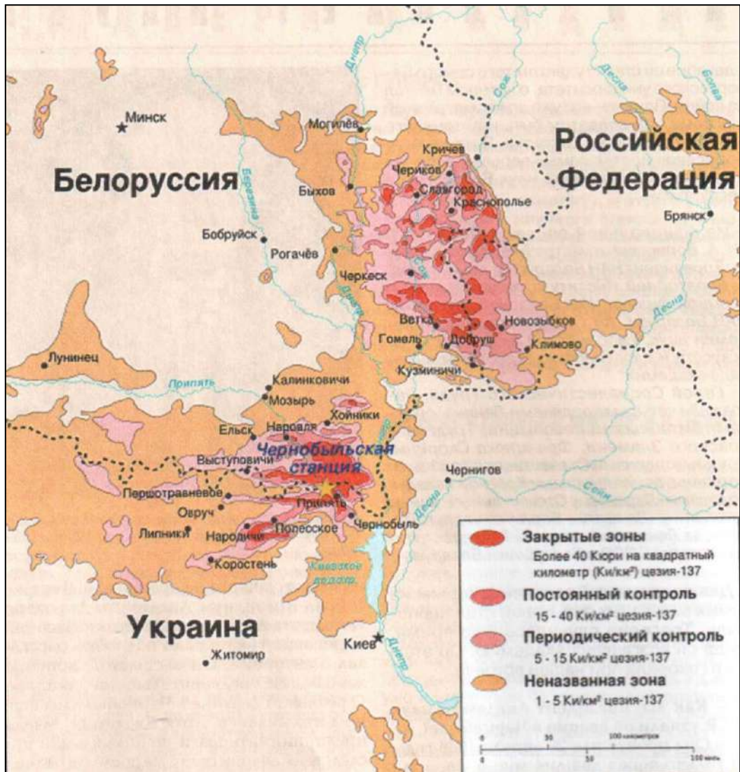
Рис. 22.21. Карта радиоактивного загрязнения изотопами цезия-137 после аварии на Чернобыльской АЭС в 1986 г. [191]
