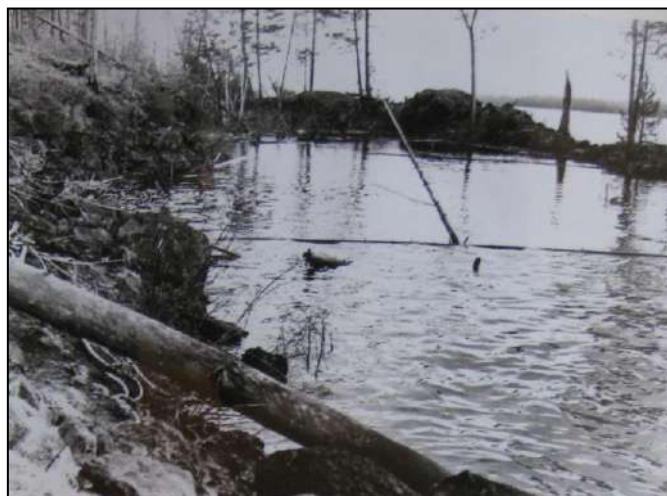
Рис. 16.29. Термокарстовый провал в левом берегу Вилюйского водохранилища в 5 км ниже устья р. Денкюке. Фото ВНИМС, 1985 г.
