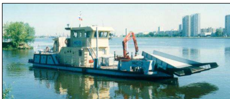
Рис. 28.15. Судно-мусоросборщик: предназначено для сбора с акваторий плавающего мусора, загрузки его в контейнеры и сдачи на специализированные суда или береговым службам
