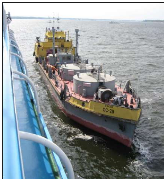
Рис. 28.13. Судно-сборщик сточных вод, причаливающее к пассажирскому теплоходу в порту г. Самары на Саратовском водохранилище
