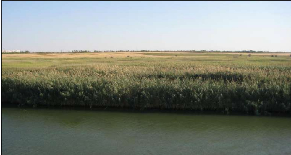
Рис. 18.3. Умеренно подтопленный левый берег Карповского водохранилища на Волго-Донском судоходном канале. Граница зоны подтопления просматривается по цвету растительности. 2009 г.
