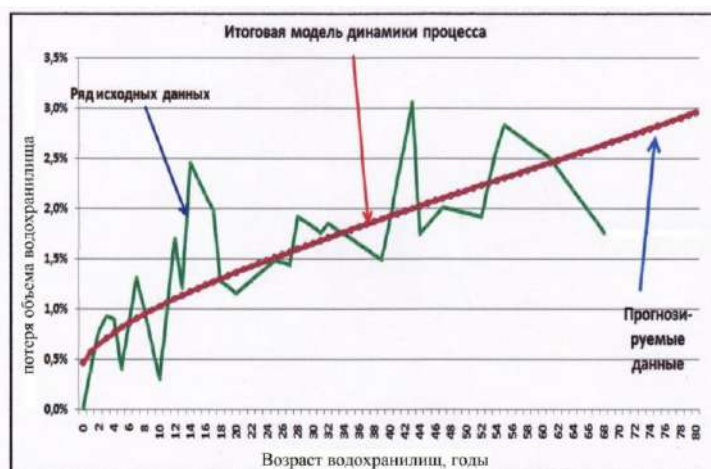
Рис. 17.12. Общая закономерность потери полного объема больших равнинных водохранилищ Европейской территории России и Украины в зависимости от возраста. Исходные данные в табл. 17.7 [539]
