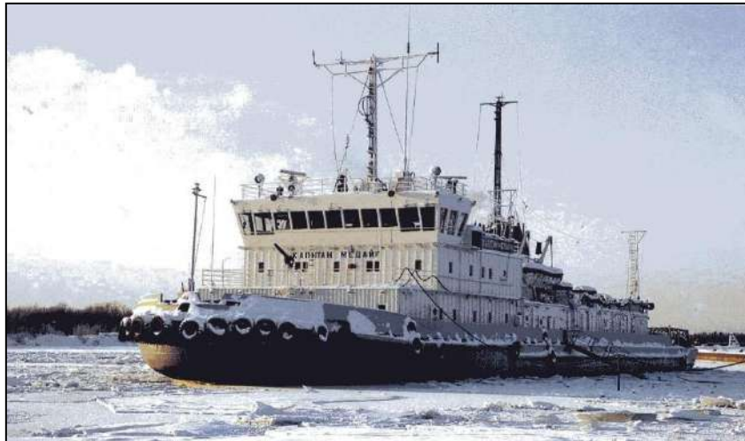
Рис. 4.29. Ледокол на р. Лене: специальная форма носа ледокола, обеспечивает практически чистый канал во льду
