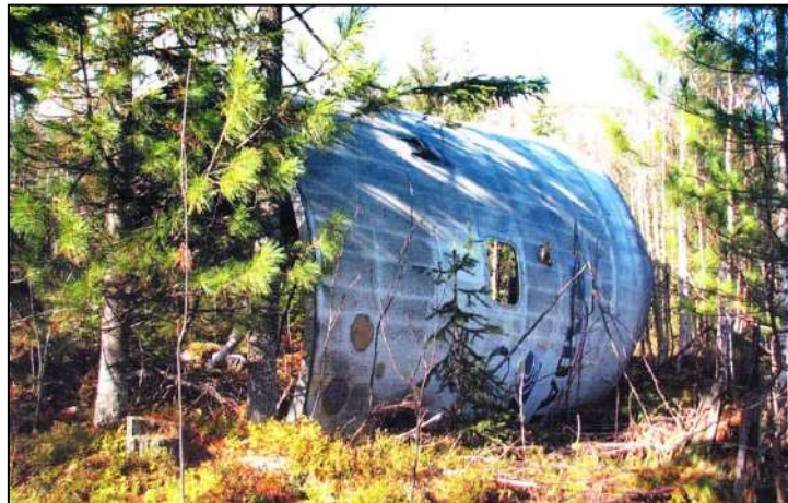
Рис. 11.6. Фрагмент отделяющейся части ракеты-носителя «Союз» пуска 2006 – 2009 гг. в районе планового падения на Северном Урале [333]
