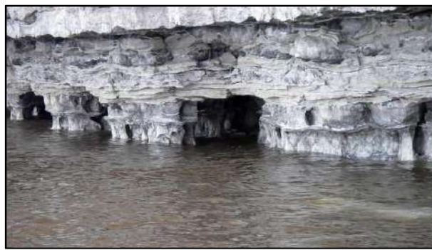
Рис. 9.2. Горные выработки по добыче палыгорскита у пос. Тетюши, затопленные Куйбышевским водохранилищем: палыгорскит (горное дерево) – минерал белого или серого цвета, применяющийся для тепло- и звукоизоляции в строительном деле [603]
