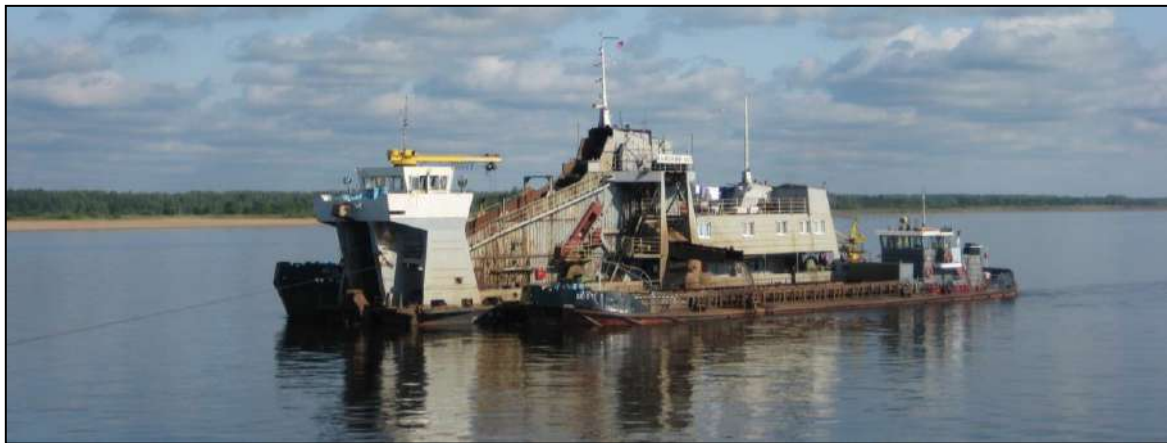
Рис. 9.5. Земснаряд на добыче гравелистого материала со дна Нижнекамского водохранилища в 70 км ниже Воткинского гидроузла. 2009 г.
