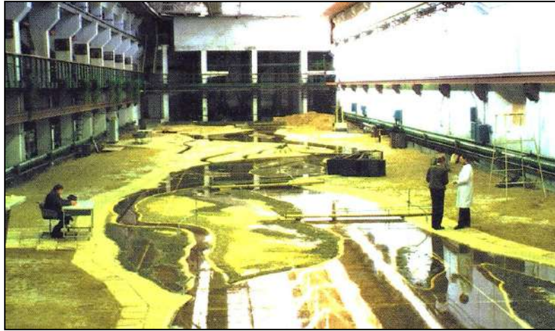
Рис. 7.6. Гидравлическая модель 40-километрового участка р. Оби в русловой лаборатории ГГИ
