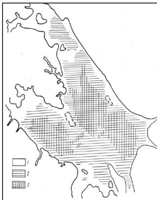
Рис. 15.6. Схема распределения глубин размывающего действия волн при ветре 20 м/с в условиях Рыбинского водохранилища: 1 – 7 м, 2 – от 7 до 8,5 м, 3 – от 8,5 до 10 м [92]
