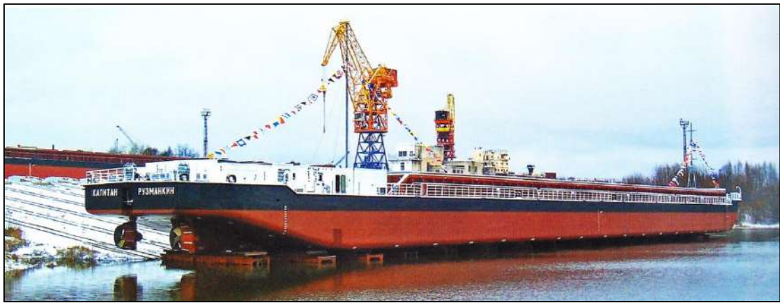
Рис. 4.8. Спуск на воду сухогруза проекта RSD – 44 «Капитан Рузманкин» на ОАО «Окская судостроительная верфь» в г. Навашино Нижегородской области
