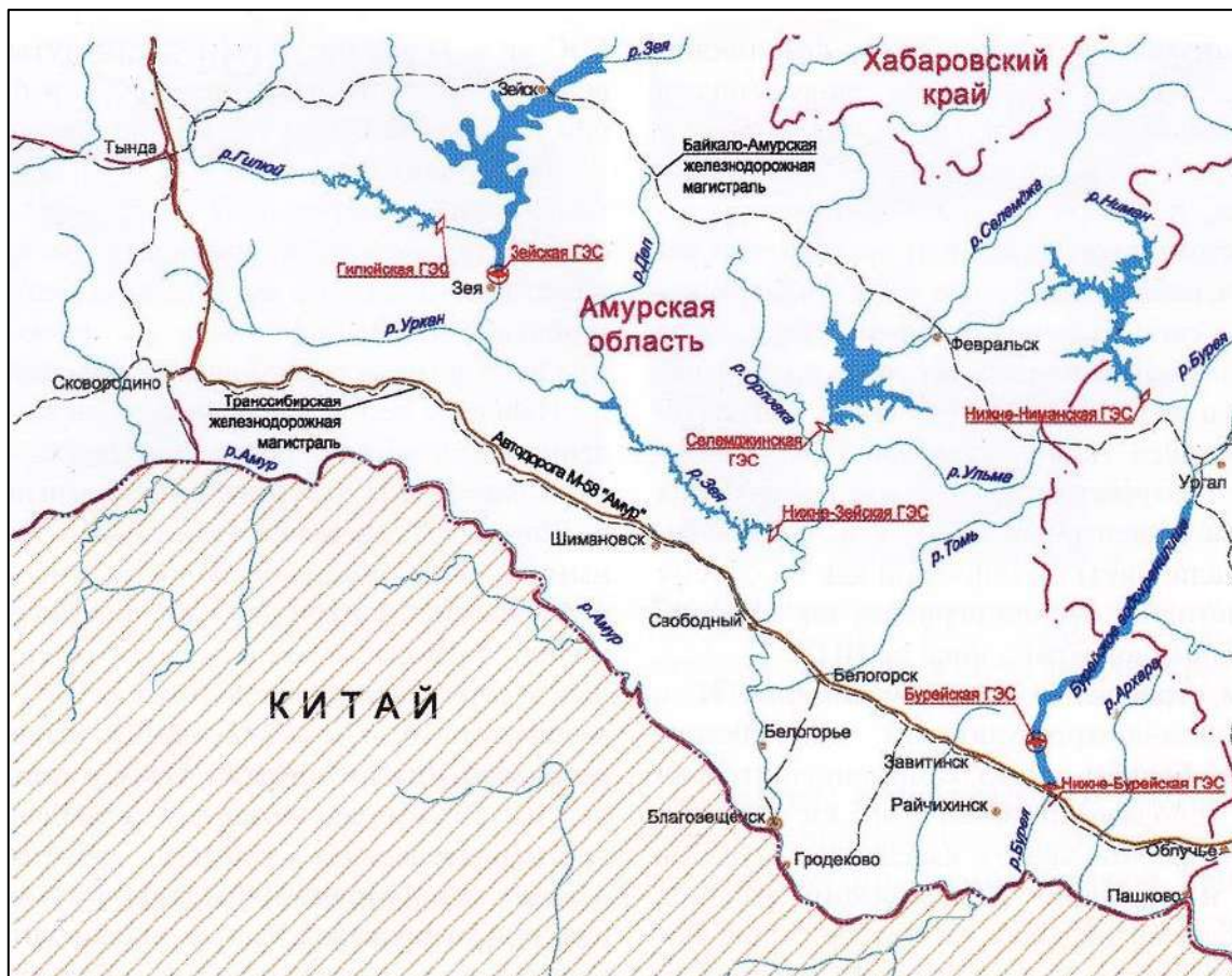
Рис. 7.10. Схема размещения действующих и перспективных гидроузлов в бассейне р. Амура [362]
