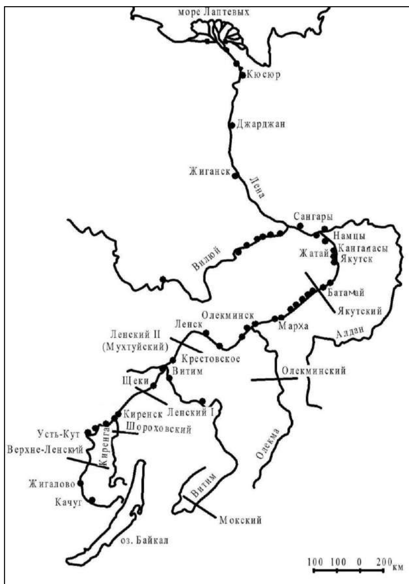
Рис. 7.11. Схема размещения перспективных энергетических гидроузлов с противоаводковыми функциями на р. Лене и притоках: точки – места крупных заторов [371]; линии – створы гидроузлов [31]
