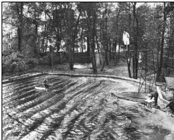
Рис. 13.7. Лабораторные исследования волнения на водохранилище во ВНИИГ имени Б.Е. Веденеева [Огонек, 1958. – №49]
