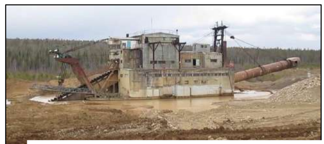
Рис. 11.7 Месторождение золота в Магаданской области, разрабатываемое драгой, после чего остается грядовый рельеф с оттаявшими грунтами. 1980-е гг.
