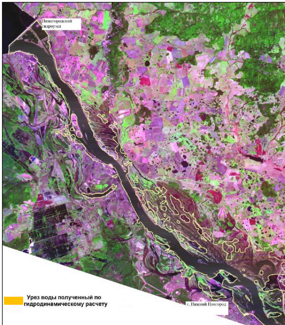
Рис.12.17. Космический снимок р. Волги на участке Нижегородская ГЭС – г. Нижний Новгород от 29.04.2001 г. с нанесенными урезами воды по данным моделирования [323]
