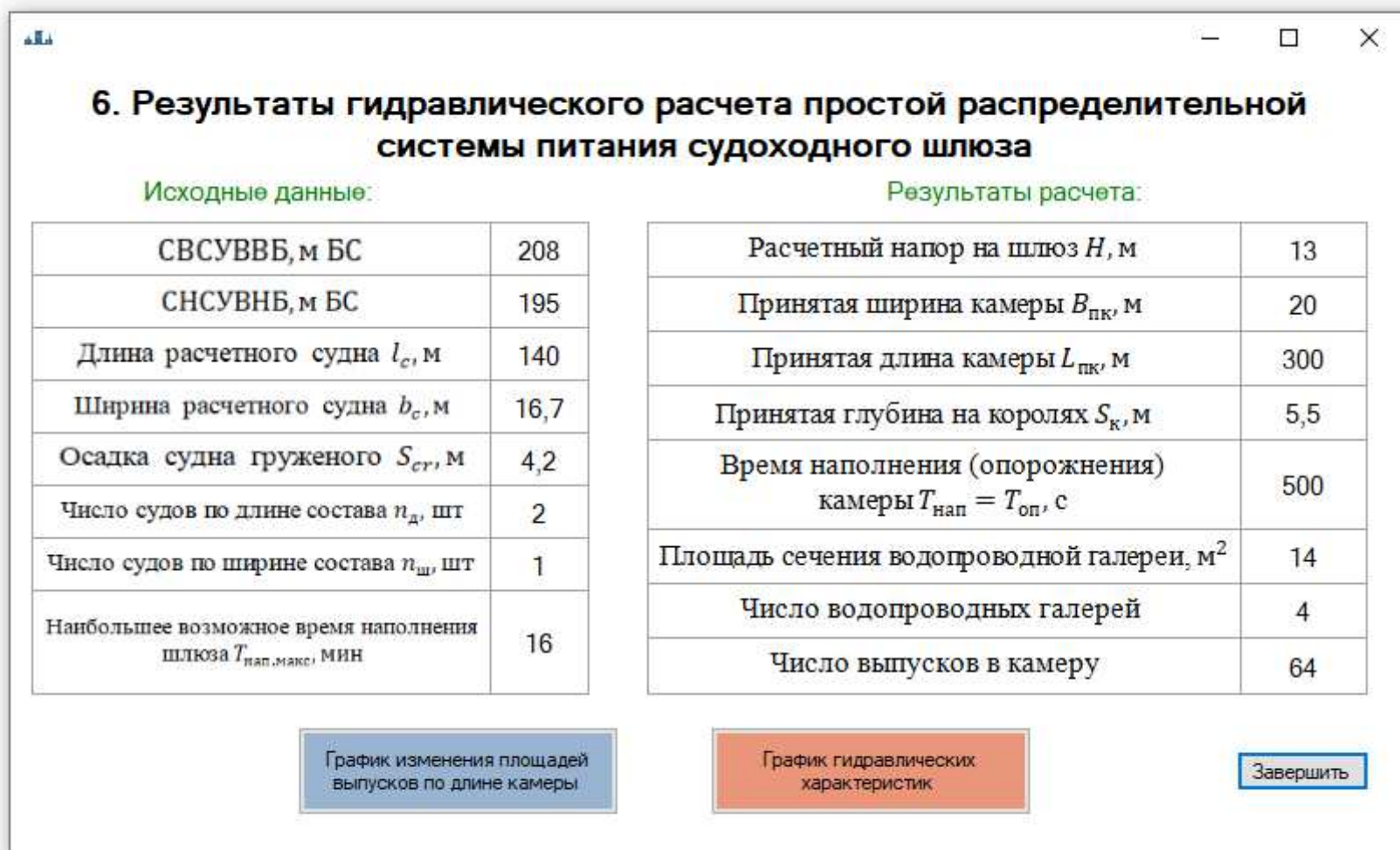
Рисунок 26 – Результаты гидравлического расчета простой распределительной системы питания Указания: после просмотра нажмите на кнопку «Завершить» и закончите расчет.
