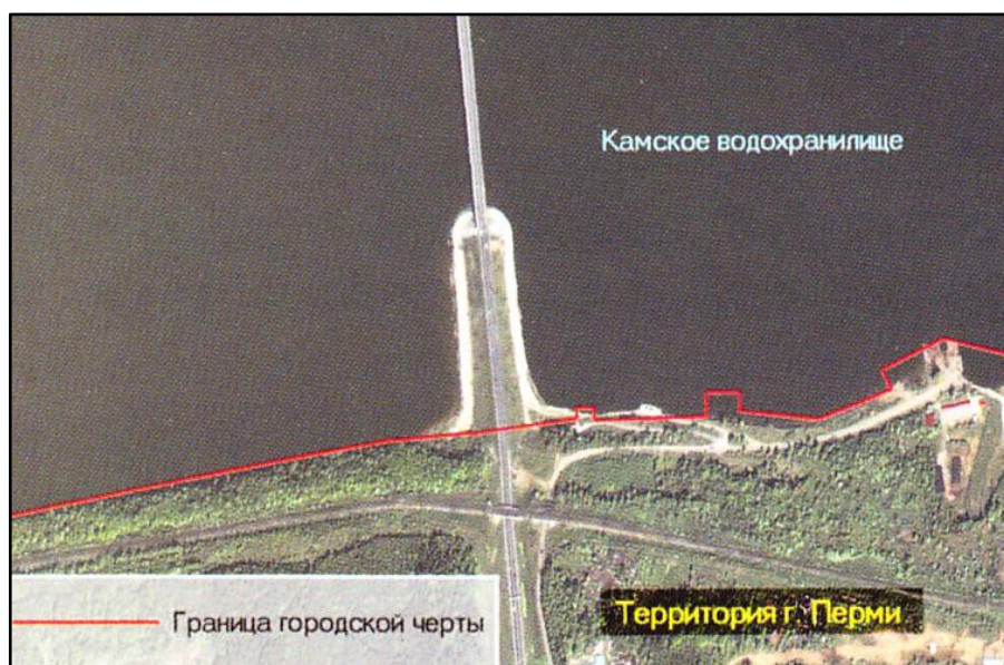
Рис. 4.13. Пример несовпадения границы городской черты г. Перми, проведенной по карте масштаба 1:2000, с береговой линией Камского водохранилища, отраженной на космическом снимке с размером пикселя 1 м [Гормаш, 2010]
