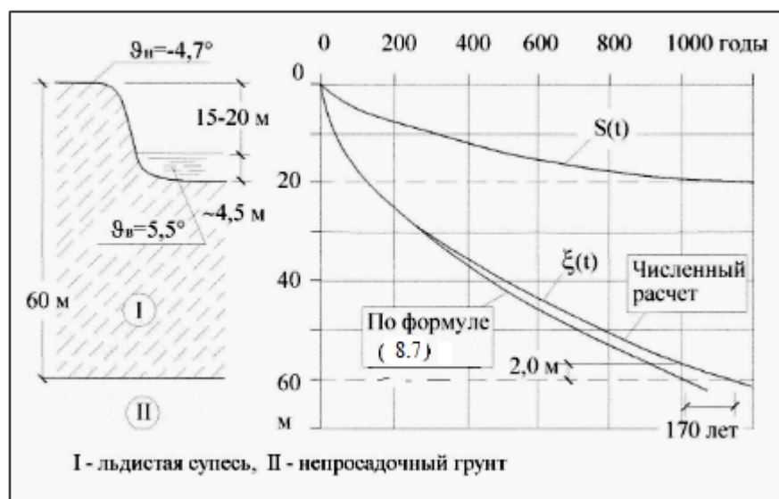
Рис. 8.32. Оттаивание основания и оседание дна оз. Сырдах
