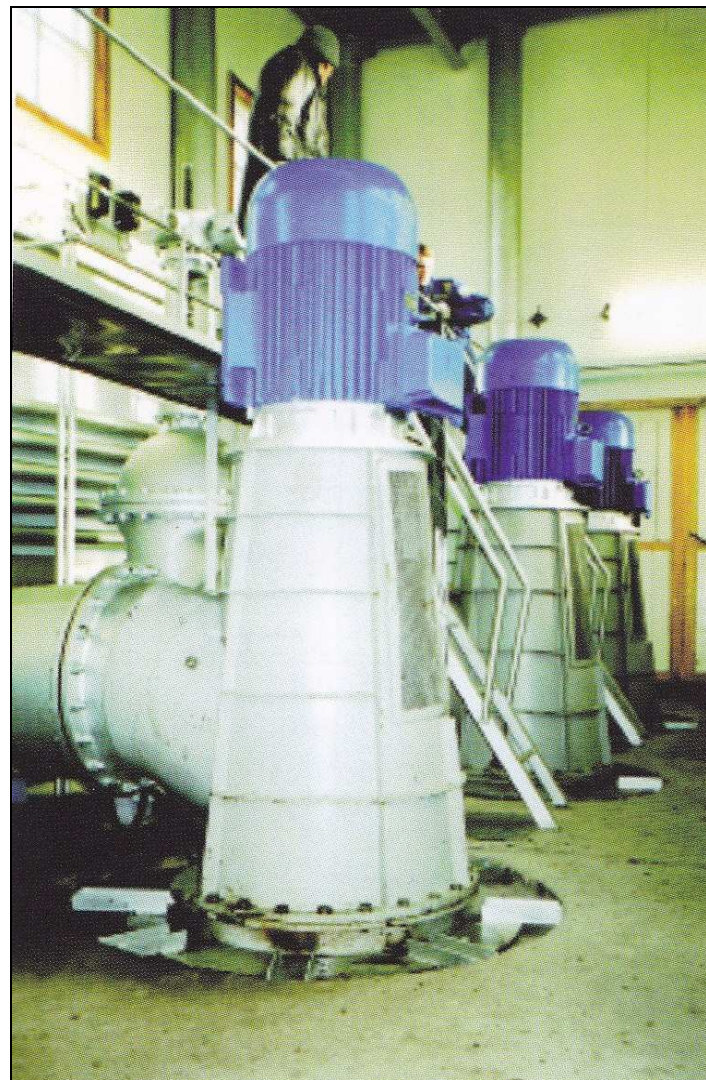
Рис. 71. Малая ГЭС мощностью 3 \times 55 кВт у п. Кызыл-Хая в Республике Тыва и ее машинный зал
