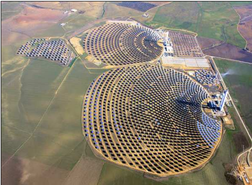
Рис. 84. Солнечная электростанция PS20 в Испании у г. Севильи: работает с 2009г.; тип – башенный; высота башни 161м; солнечные лучи фокусируются 1255 зеркалами площадью каждое 120 м 2 ; к.п.д.=20%; мощность 20 МВт; на втором плане – СЭС PS 10
