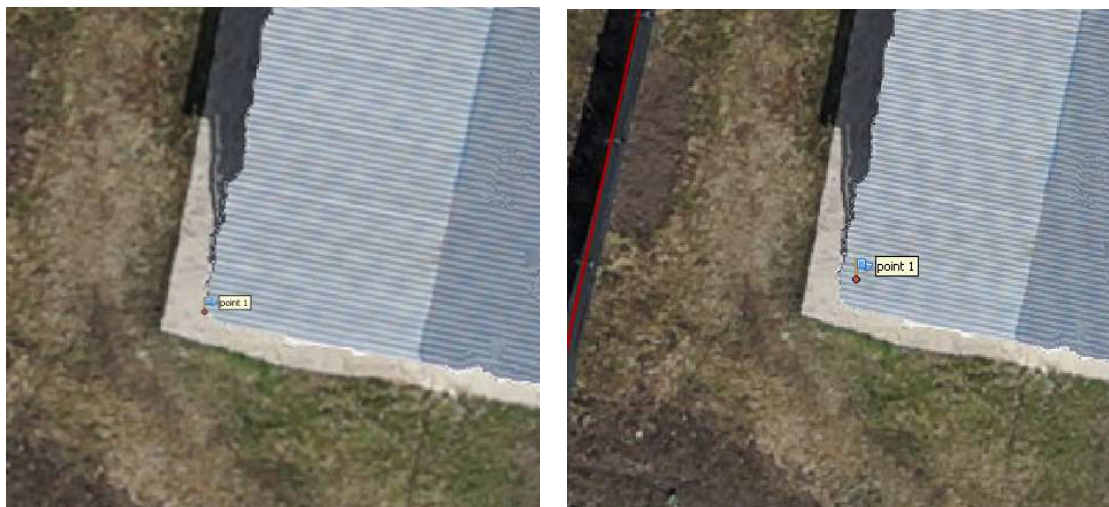
Рисунок 1 – Изначальное положение маркера по ортофотоплану и уточненное положение маркера.
