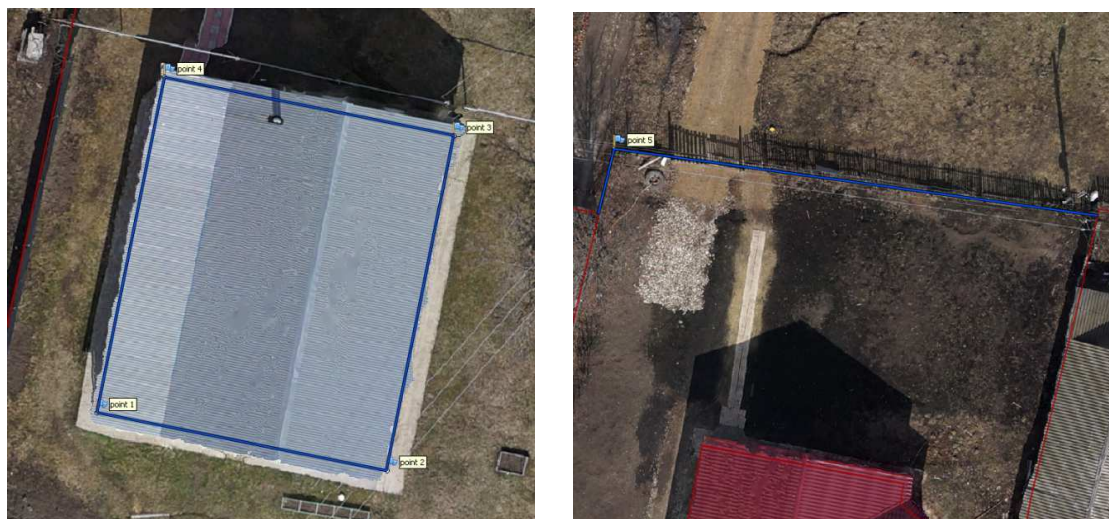
Рисунок 3 – Установление контура объекта недвижимости и границы земельного участка.
