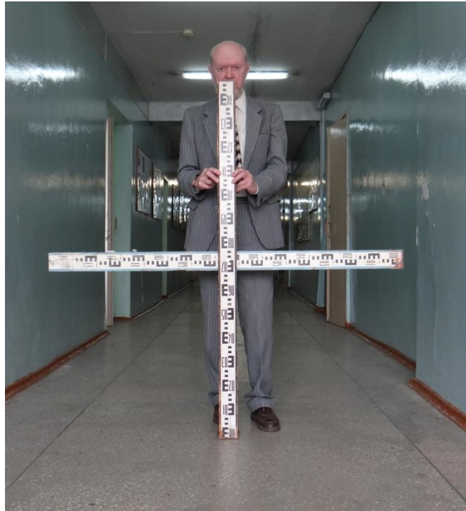
Рис. 77. «Крест» для фотографическое способа контроля планово-высотного положения подкрановых рельсов.
