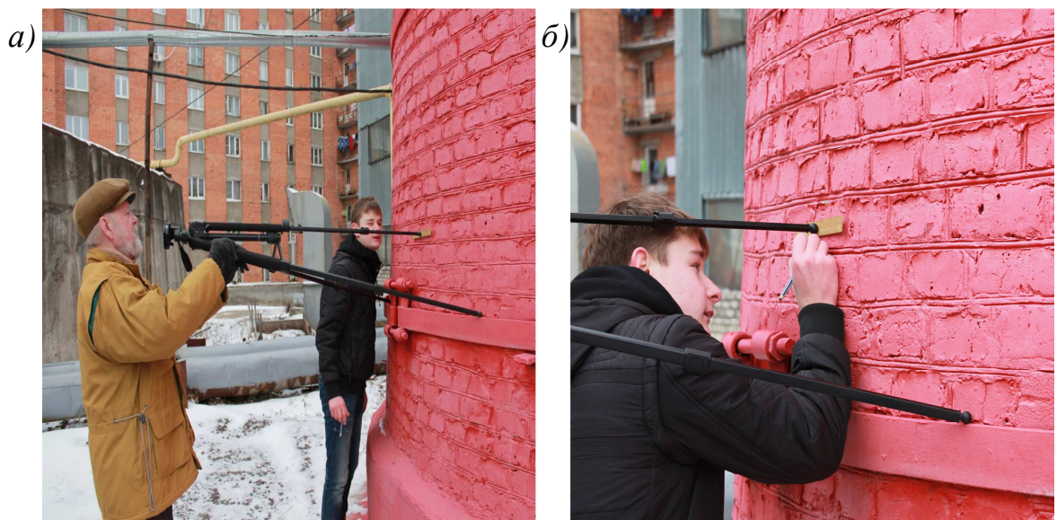
Рис. 21. Определение направления визирного приспособления на точку T ( a ) и отмечание на трубе вспомогательной точки ( b )
