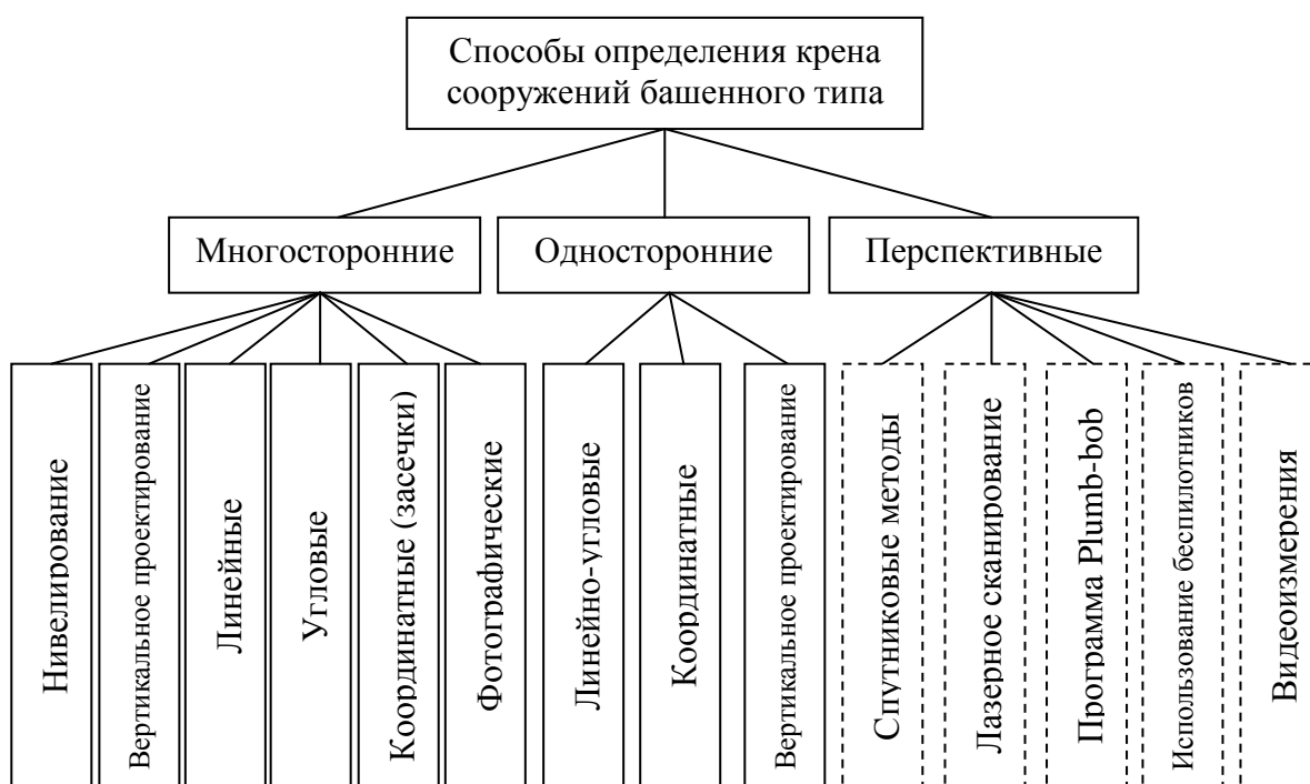
Рис. 1. Классификация способов определения крена сооружений башенного типа
