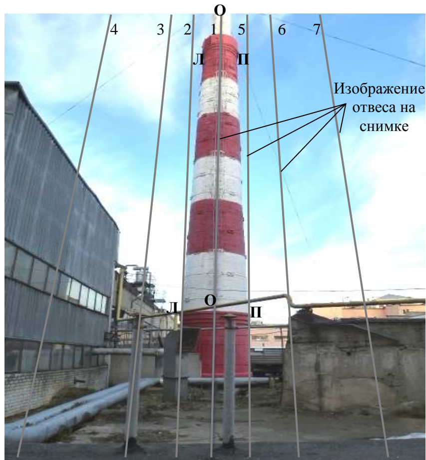
Рис. 88. Расположение отвеса относительно оси трубы
