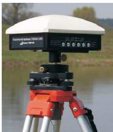
Рис. 72. Основные блоки спутниковой геодезической системы: а) 1 – спутниковый приемник (антенна); 2 – контроллер; б) двухсистемный геодезический приемник ГЛОHACC/GPS GEO-161
