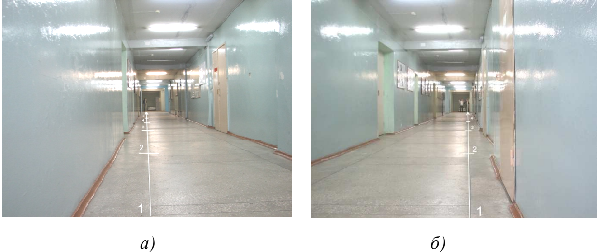
Рис. 46. Закрепление точек на линиях, имитирующих подкрановые рельсы
