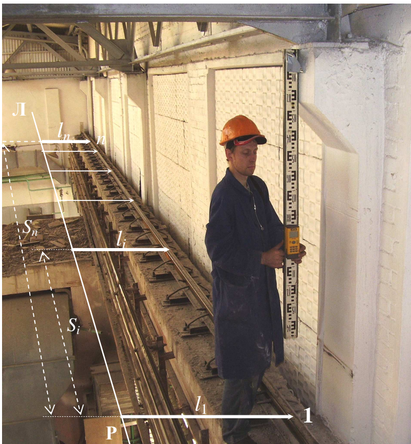
Рис. 115. Схема фотографического способа контроля прямолинейности рельса
