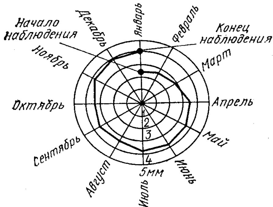
Рис. 137. График хода раскрытия трещины
