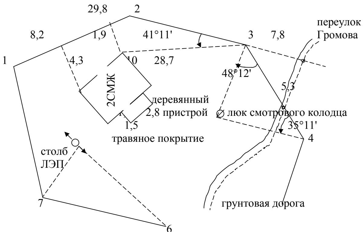
Рис. 74. Абрис теодолитной съемки
