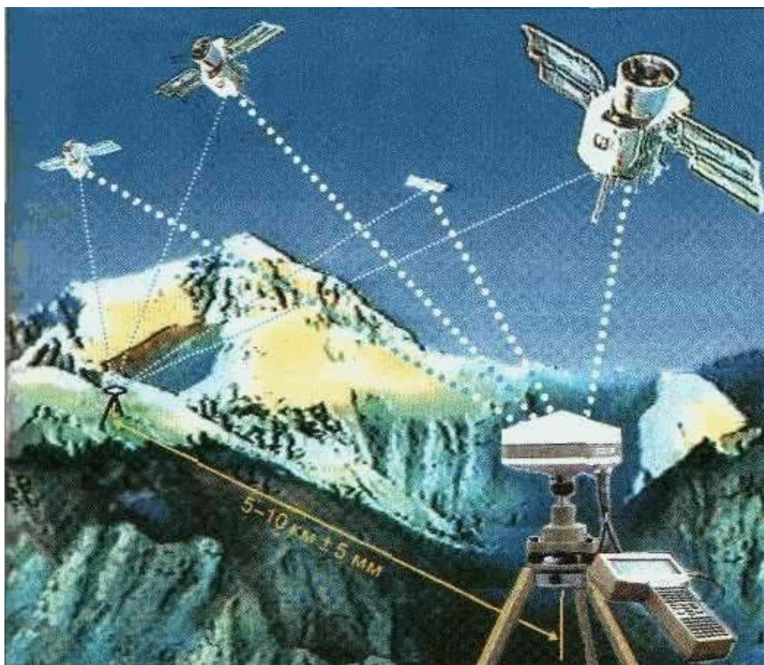
Рис. 71. Схема измерения координат точек земной поверхности спутниковыми приемниками
