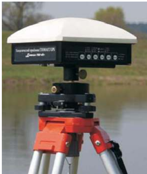
Рис. 72. Основные блоки спутниковой геодезической системы: а) 1 – спутниковый приемник (антенна); 2 – контроллер б) двухсистемный геодезический приемник ГЛОНАСС/GPS GEO-161
