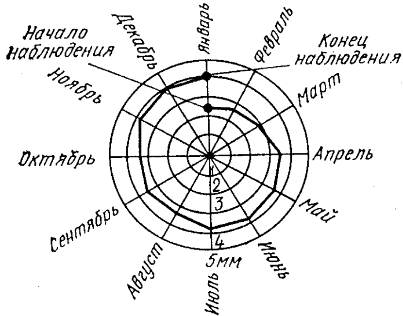
Рис. 114. График хода раскрытия трещины
