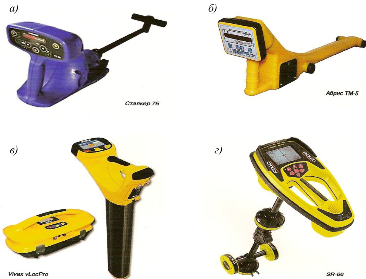
Рис. 108. Приборы поиска подземных коммуникаций
