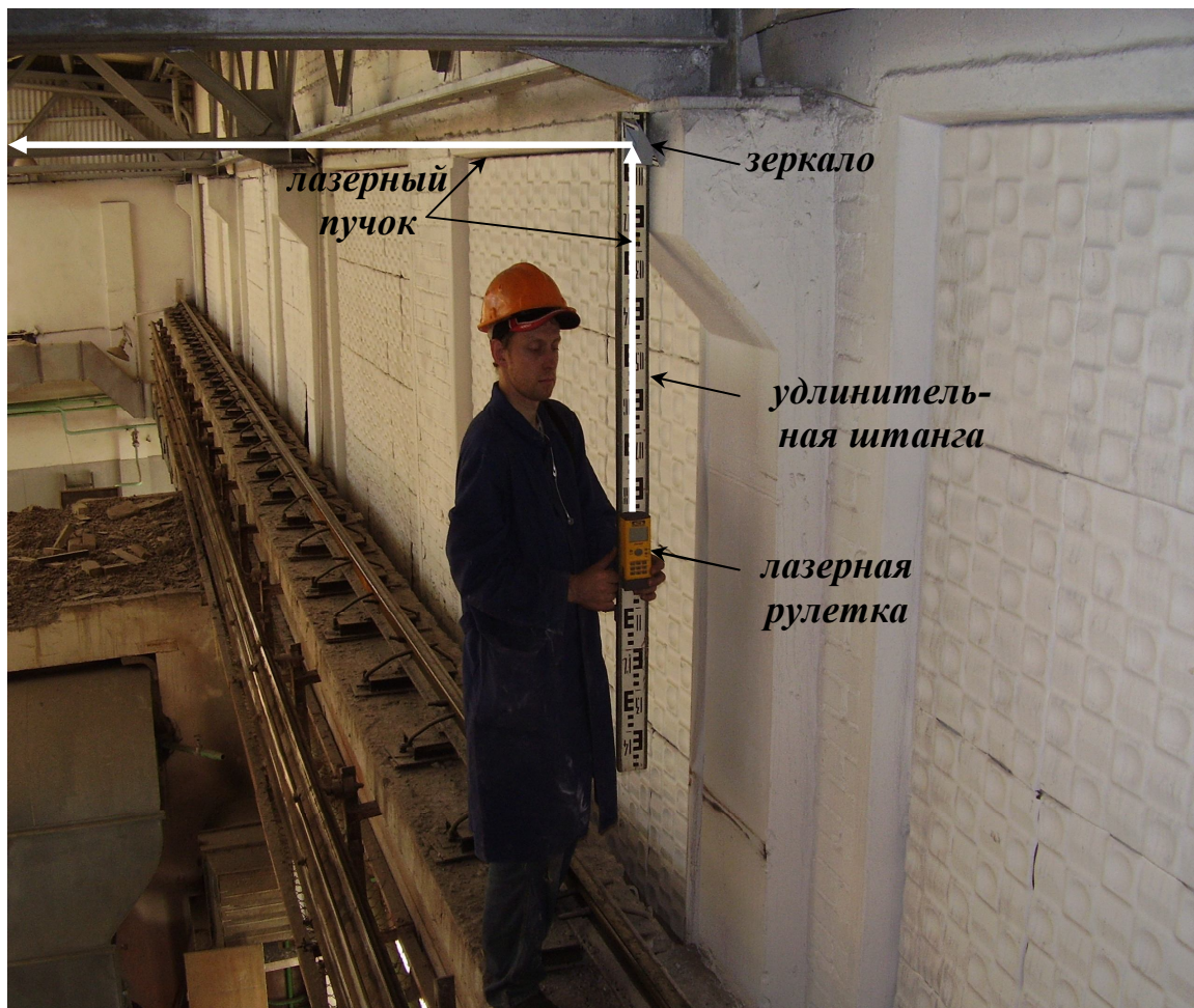
Рис. 53. Пример использования ЛЗУ для измерения расстояния между колоннами в пролёте на уровне их оголовка
