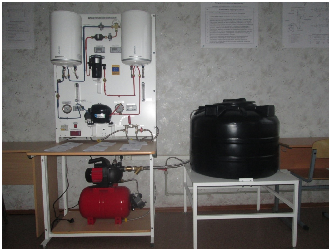
Рис. В.3. Лабораторная установка «Нетрадиционные и возобновляемые источники энергии – Тепловой насос»
