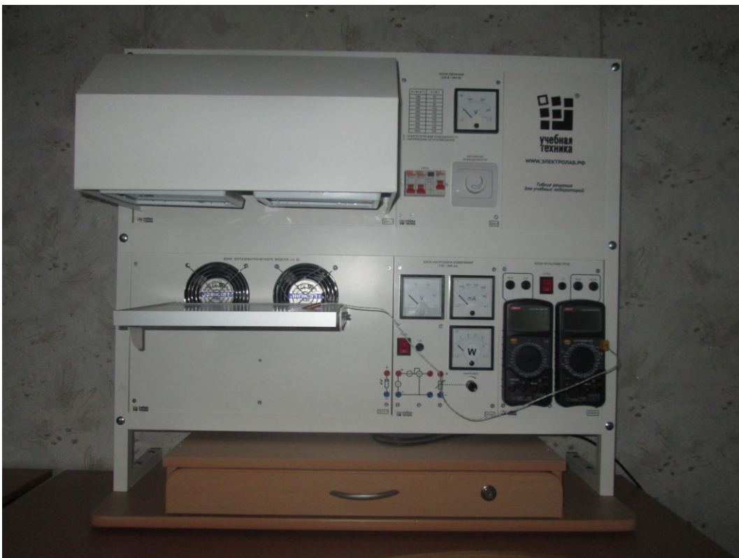
Рис. В.2. Лабораторная установка «Нетрадиционная электроэнергетика – Фотоэлектрический модуль»
