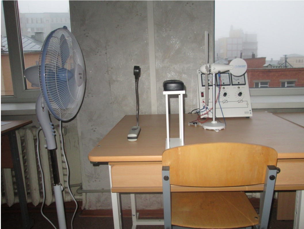
Рис. В.1. Лабораторная установка «Нетрадиционная электроэнергетика – Натурная модель ветроэлектрогенератора»
