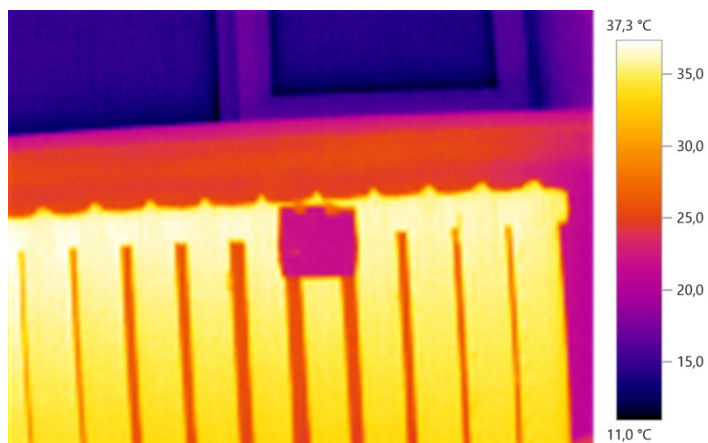
Рис. 4.17. Термограмма отопительного прибора с установленным на нем отражателем
