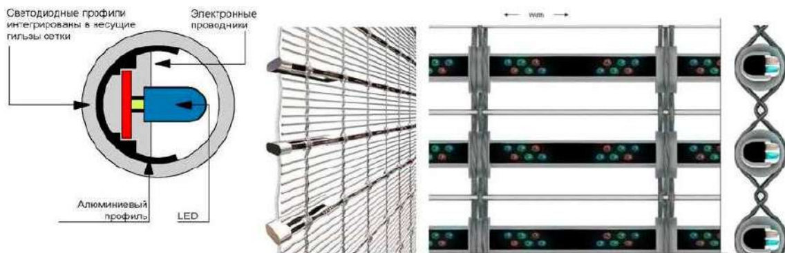
Рис.2. Конструкция полотна «Mediamesh»
