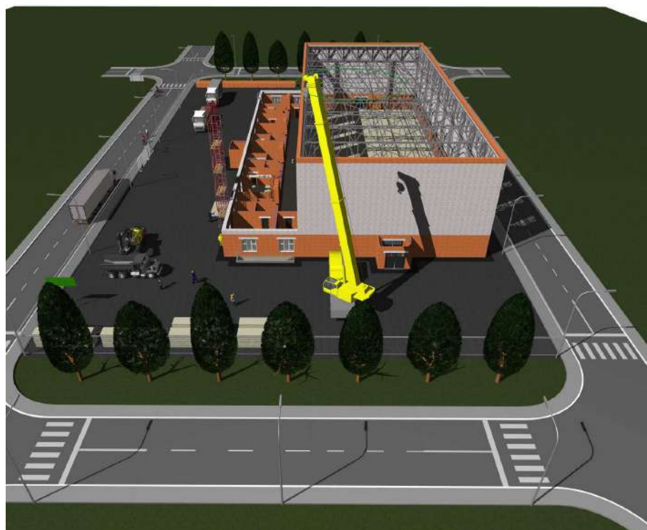
Рис. 2. Проект организации строительства (ПОС) в 4D
