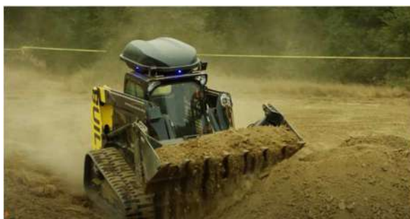
Рис. 2. Автономный гусеничный погрузчик на базе Bobcat T590.
