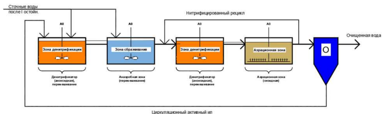
Рис. 5. Процесс Modified Johannesburg (MJNB)
