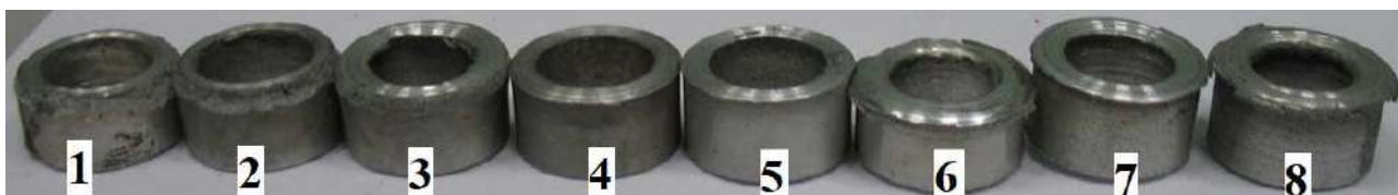
Рис 3. Образцы после испытания по схеме «цилиндр-тормозная колодка»
