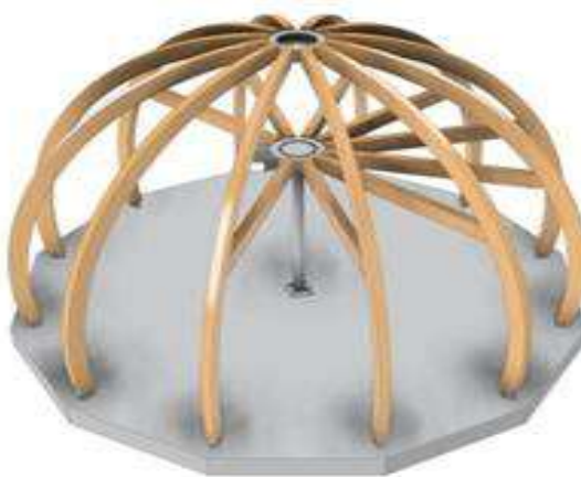
Рисунок 5 – Конструкция стратодезического купола.
