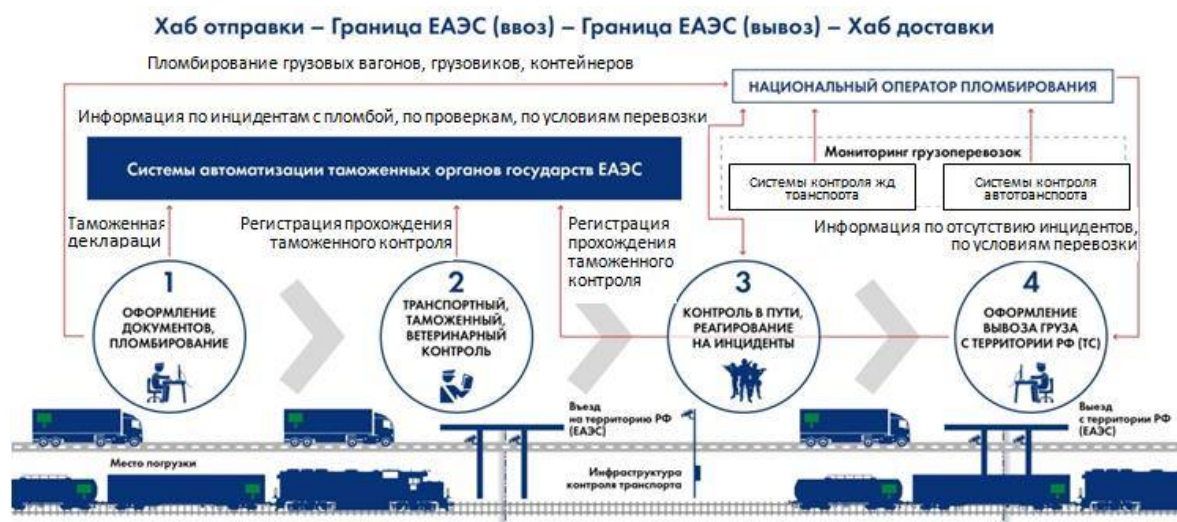
Рис. 3. Применение электронных пломб для контроля перевозок и состояния груза при транзите через территорию РФ и ЕАЭС
