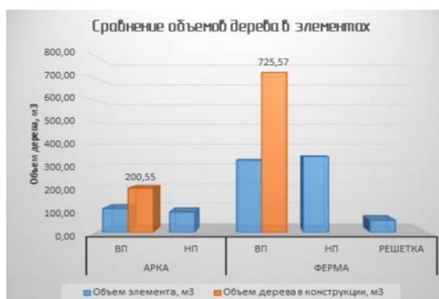
Рис. 1. Сравнительный анализ объемов дерева для конструкции арки и фермы
