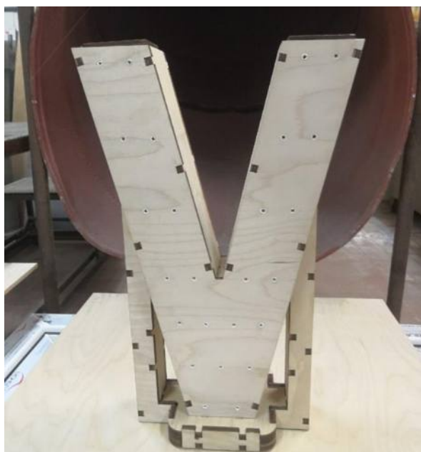
Рис.1. Макет здания, помещенный в аэродинамическую трубу
