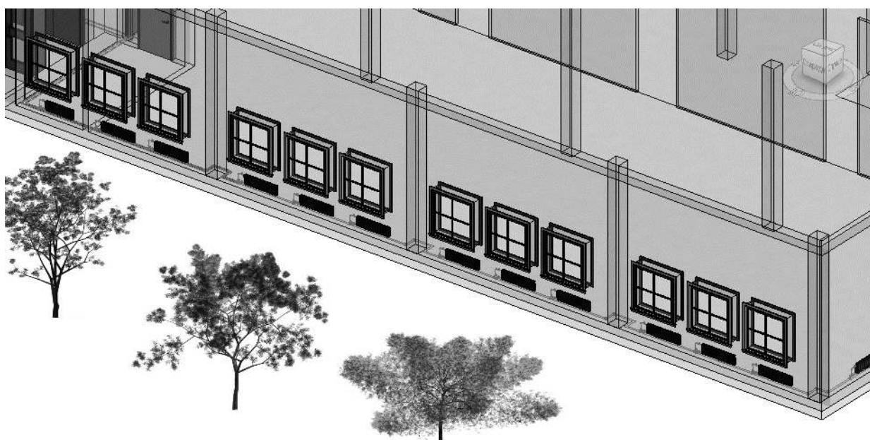
Рис. 5. Фрагмент системы отопления ресторана (Прыткова Е.М.)
