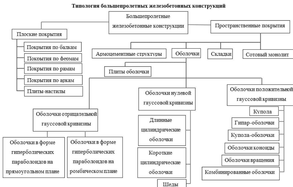
Рисунок 1 – Типология большепролетных железобетонных конструкций
