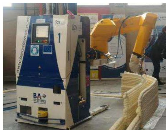
Рис.6 3D – принтер – манипулятор создаёт фрагмент здания
