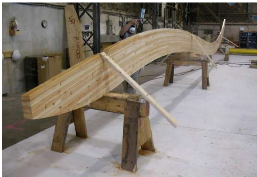
Фото 4. Деревянная клееная деталь
