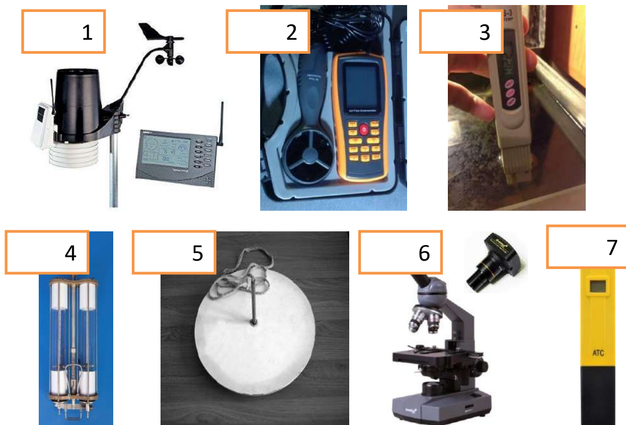
Рис.1. Состав мобильного измерительного комплекса, включающий 1- профессиональную Интернет метеостанцию, 2- анемометр Мегеон 1103, 3- термометр для измерения температуры воды, 4 - батометр Молчанова, 5- диск Секки, 6- микроскоп с цифровой камерой, 7- рН-метр.
