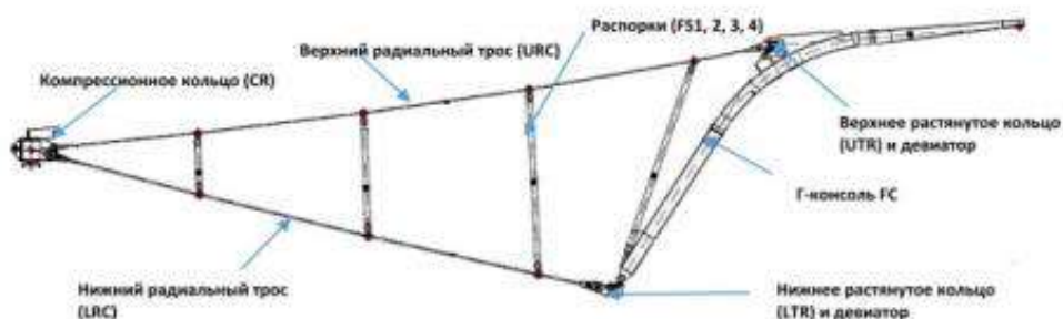
Рис. 4. Вантовая конструкция кровли стадиона «Волгоград Арена»
