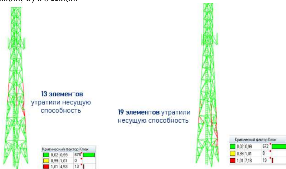
Рисунок 2 – Результаты расчета в линейно-статической постановке (коэффициенты использования) разрушение элемента пояса в 5-ой и 6-ой секции соответственно
