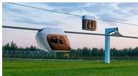
Рис. 11. SW-полигон: юнибус на лёгкой, юнибайк (ближе) на полужёсткой трассах
