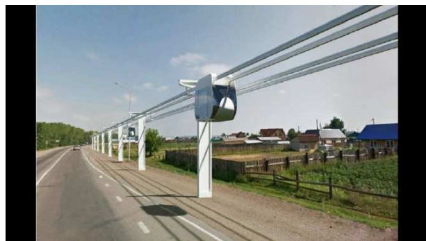
Рис. 11. Подвесной пассажирский юнибус на полужёсткой рельсо-струнной путевой SW-структуре на промежуточных опорах
