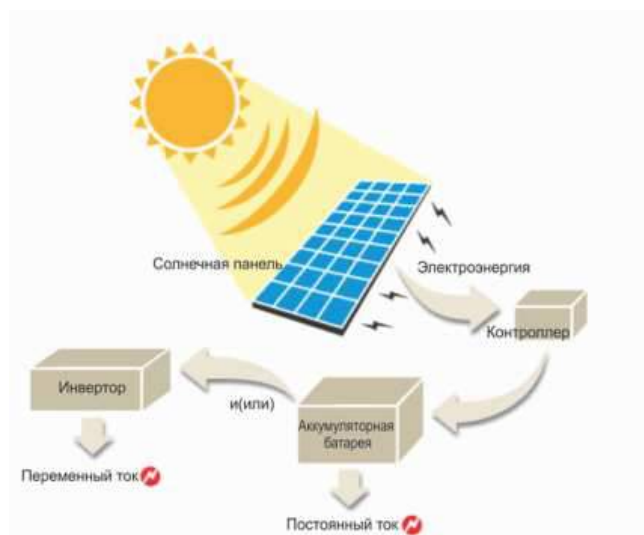
Рис.2. Схема электропитания от солнца [2]
