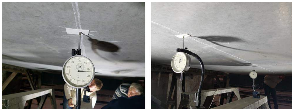
Рис. 2. Схема расстановки индикаторов часового типа для определения прогибов.
