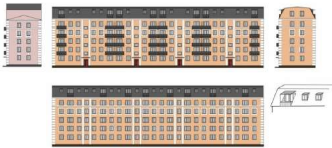
Рис. 3. 2-D проект реконструкции здания с мансардным этажом
