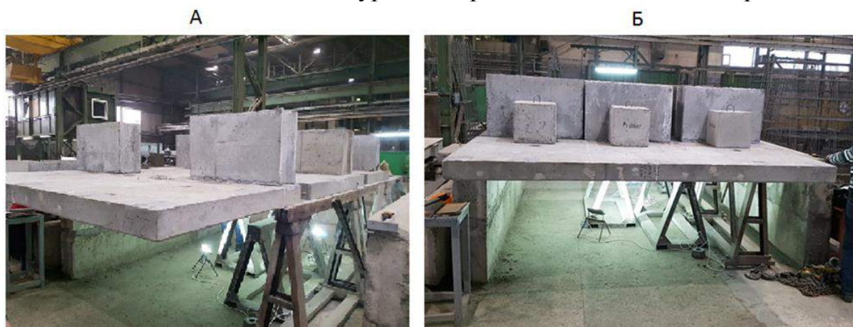
Рис. 1. Специальный стенд для испытания натурального образца ж/б плиты.
