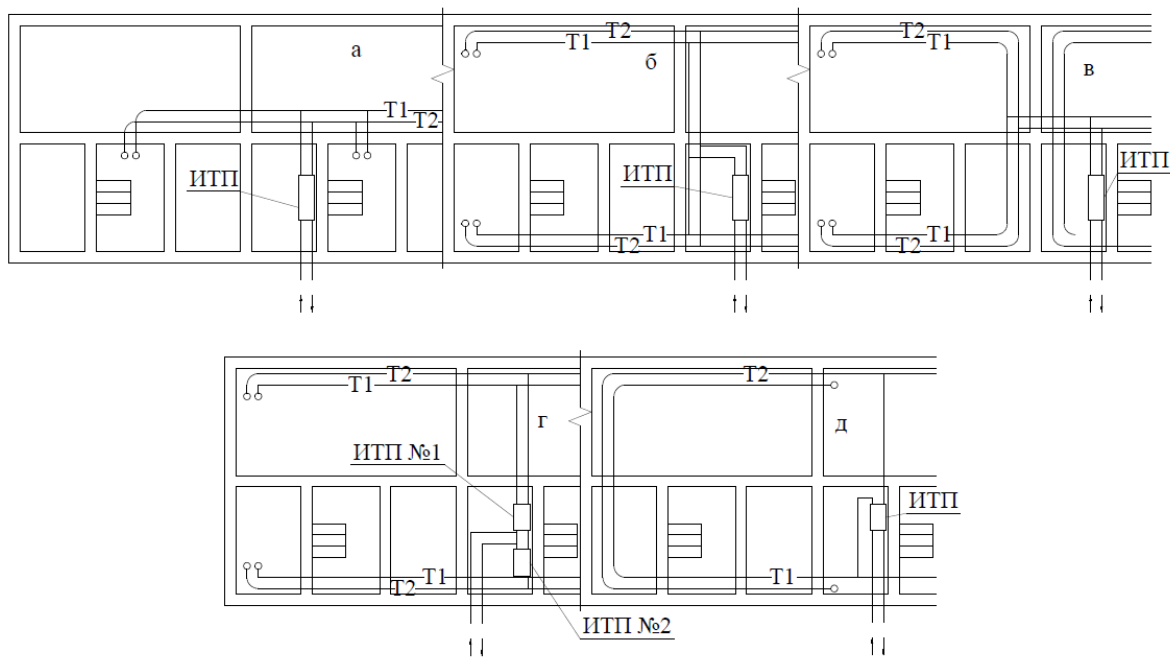
Рис.2. Схемы нижней (верхней) разводки магистралей систем отопления: а - тупиковой с поквартирными ветками; б - тупиковой; в - тупиковой посекционной; г - тупиковой пофасадной; д - с попутным движением теплоносителя
