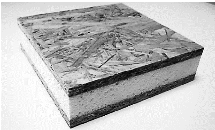
Рис. 1. Структурно-изолированные панели ( Structural Insulated Panel )
