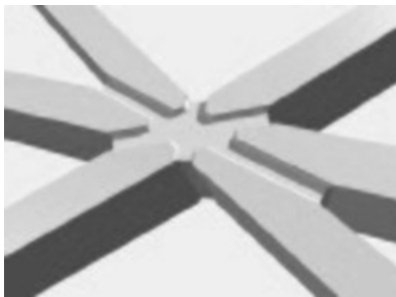
Рис. 2 Типовой узел сочленения элементов сетчатой оболочки
