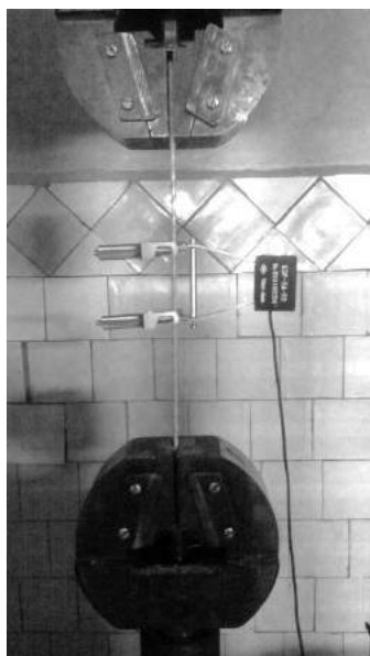
Рис.1. Измерение деформации с помощью экстензометра EDP-5A-50
