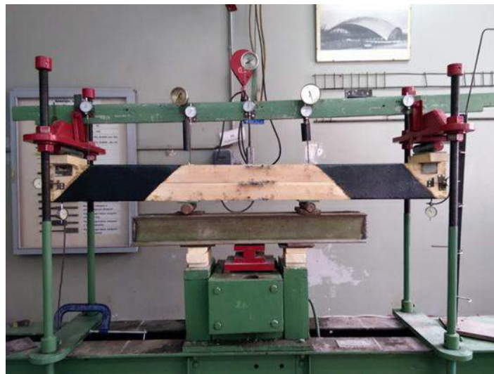
Рис.1. Испытание составной балки соединенной однонаправленной тканью из углеродного волокна на прессе.
