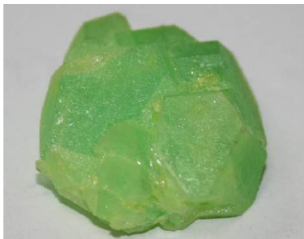
Рис. 2. Фотография кристаллов \text{Ca}_{2-x}\text{Li}_{2x}\text{GeO}_4 , выращенных с использованием затравочных кристаллов
