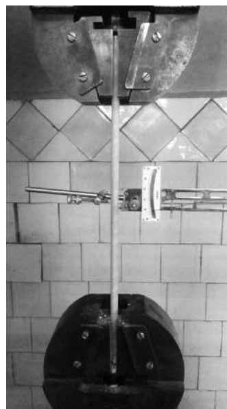
Рис.2. Измерение деформации с помощью рычажного тензометра Гугенбергера
