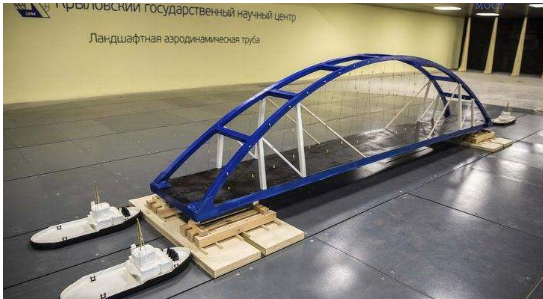
Рис.1. Модель транспортировки арочной конструкции
