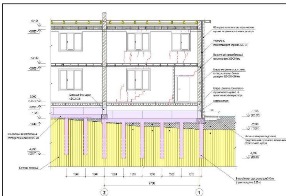
Рис.3. Трещины в несущей части наружной продольной стены, ориентированной по оси «А» на участке в осях «2»-«1». Под ростверком залегает не слежавшаяся насыпь мощностью 0,5 м, в результате чего верхняя часть ствола сваи исключается из работы, а насыпь под ростверком не обладает достаточной несущей способностью.
