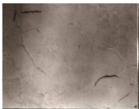
Рис. 2. Полосы скольжения на поверхности образца диаметром 5 мм из стали марки 60С2А, закаленного на HRC = 52, испытанного при вращении изогнутого образца до разрушения при температуре 20°С; ( \times 440 ); \sigma = 416 МПа; N = 9,21 \cdot 10^4 циклов; шлиф не травлен: а) и б) разные места на шлифе образца
