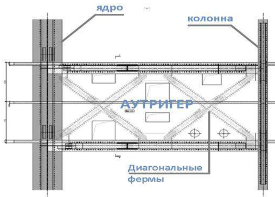
Рис.3. Конструкция аутригерного этажа в башне «Лахта-центра»
