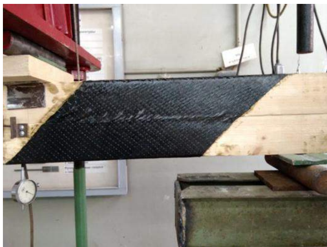
Рис. 2. Смятие волокон углеродного волокна на стыке двух составных элементов балки.
