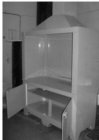
Рис. 2. Гальванический шкаф ПГ «Гальвано Групп»
