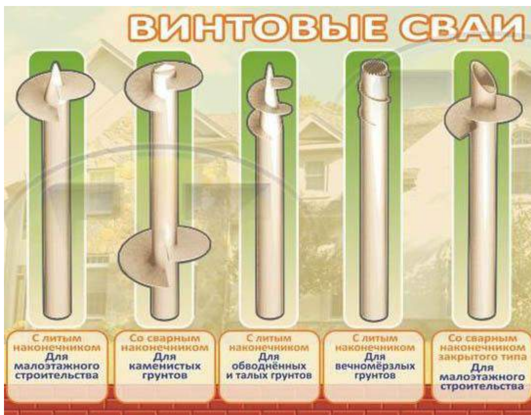
Рис. 2. Сваи для разных типов грунтов
