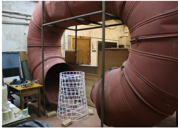
Рис. 1 Испытание макета в аэродинамической трубе
