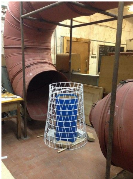
Рис. 2. Испытание макета в аэродинамической трубе
