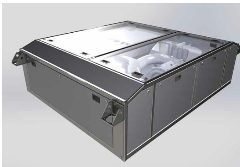
Рис. 1. Конструкция воздушной климатической системы (ВКС)
