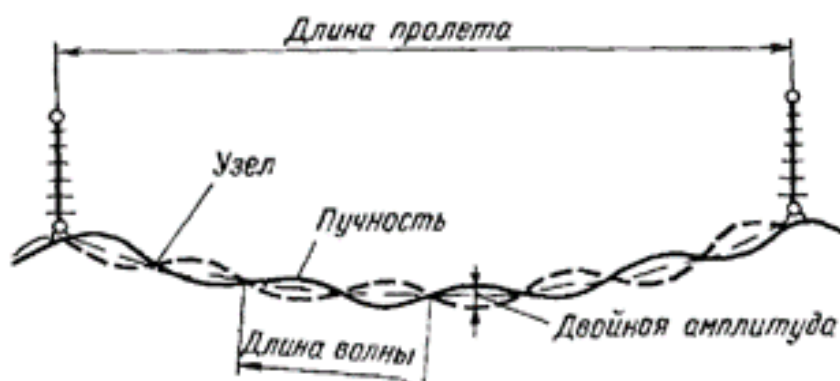
Рис. 1. Волны вибрации на проводе в пролете
