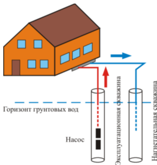
Рис. 1. Схема открытой системы использования низкопотенциальной тепловой энергии грунтовых вод
