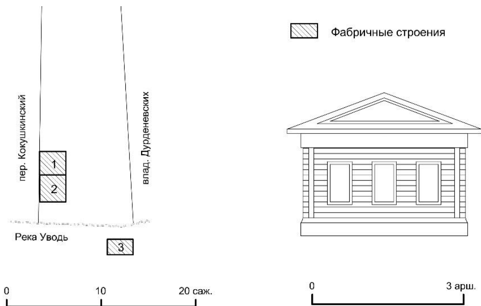
Рис. 2. Усадьба И.И. Худякова на берегу р. Уводи в г. Иваново-Вознесенск. 1874 г. Схема генплана. Проект сторожки. 1. Сторожка жилая; 2. Хозяйственный сарай; 3. Мытилка [7]
