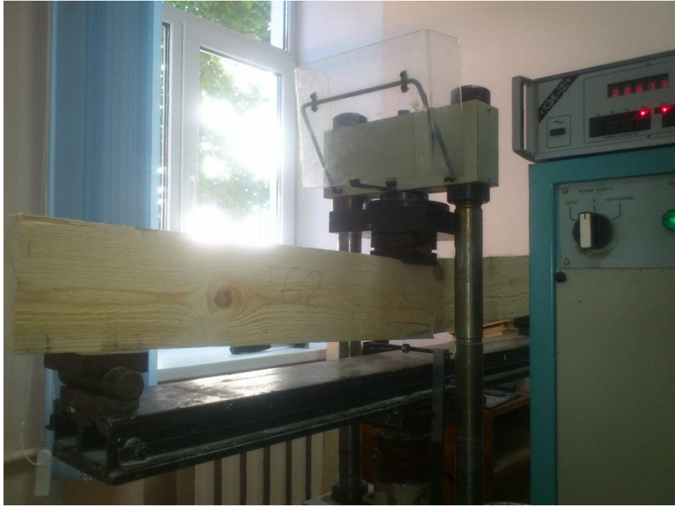
Рис. 2. Испытание балки Б2 без закрепления на прессе СИ-2-100-УХЛ4.2
