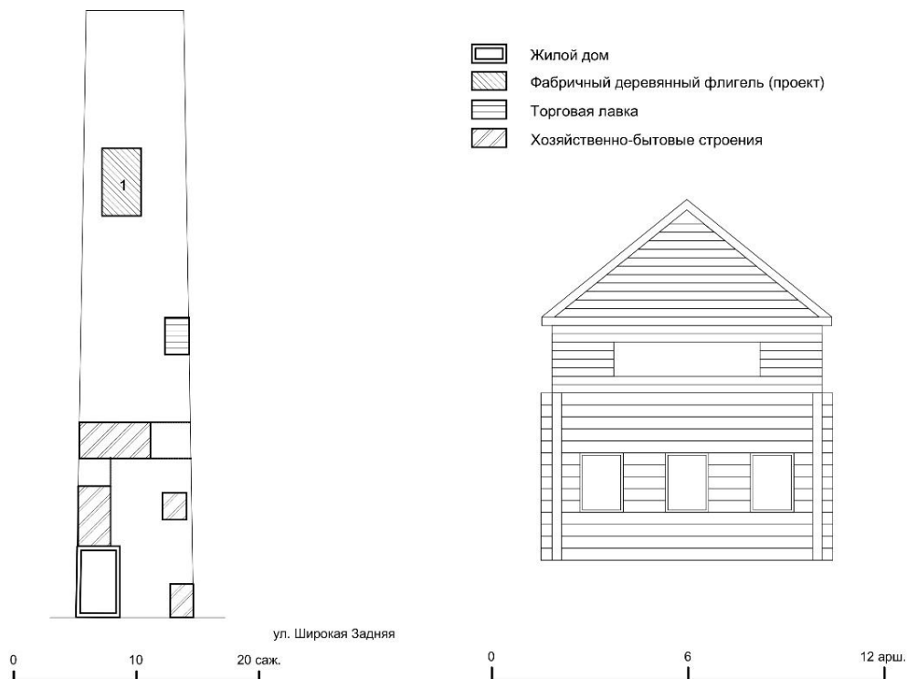
Рис. 4. Усадьба Г.В. Давыдова на ул. Широкой Задней в г. Иваново-Вознесенск. 1874 г. Схема генплана. Проект сушильных вешалов над деревянным фабричным корпусом. 1. Фабричный деревянный корпус [9]
