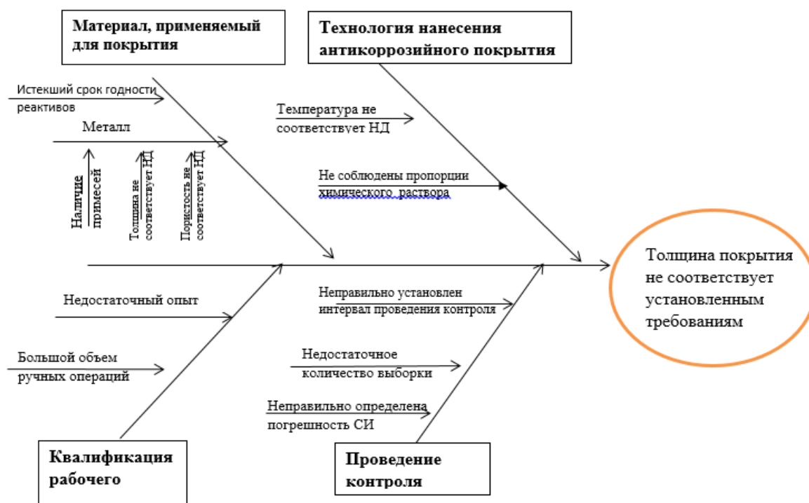
Рис. 1. Анализ причин неравномерной толщины антикоррозионного покрытия газопровода
