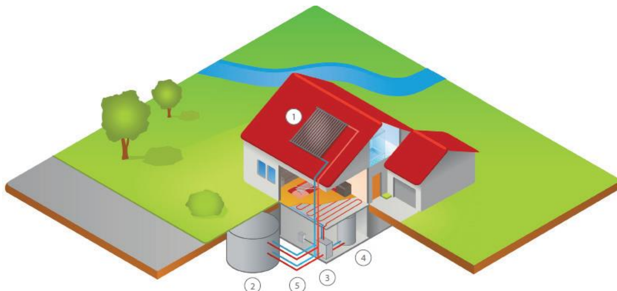
Рис. 1. Принципиальная схема системы SolarEis: 1 – солнечно-воздушные коллекторы; 2 – подземное хранилище; 3 – тепловой насос; 4 – буфер горячей воды; 5 – система управления
