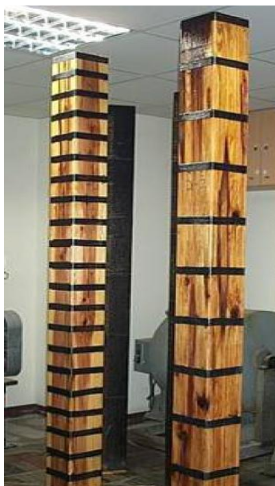
Рис. 1. Пример усиления деревянного сжатого элемента углепластиком
