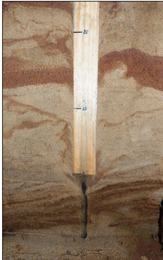
Рис.6. Вертикальный разрез массива грунта после забивки сваи. При погружении лидирующий стержень-наконечник, расположенный в острие сваи движется вдоль направляющей лидерной скважины
