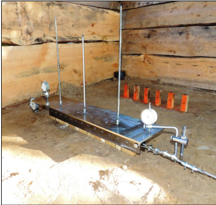
Рис.7. Подготовленная к испытаниям модель свайного фундамента из 6-ти, расположенных в 1 ряд, свай
