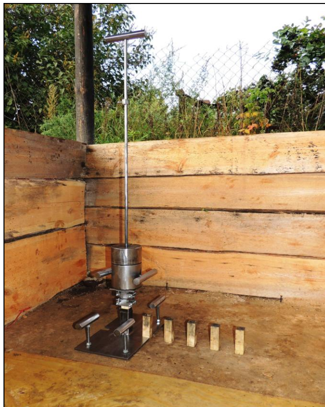
Рис.4. Ручной молот и кондуктор в рабочем положении. Молот поднимается за боковые ручки до фиксированной высоты и сбрасывается. При этом наносится удар по наголовнику, предохраняющему сваю от разрушения
