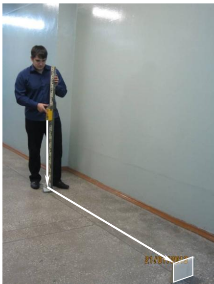
Рис. 3. Измерение базисов с помощью ЛЗУ
