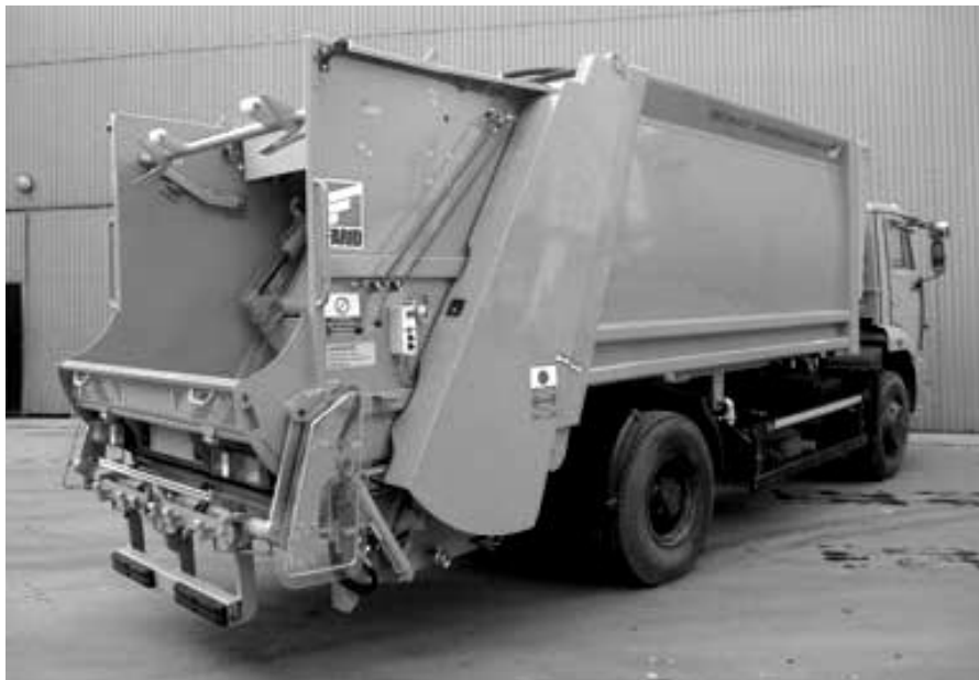
Рис.1. Мусоровоз с технологией уплотнения
