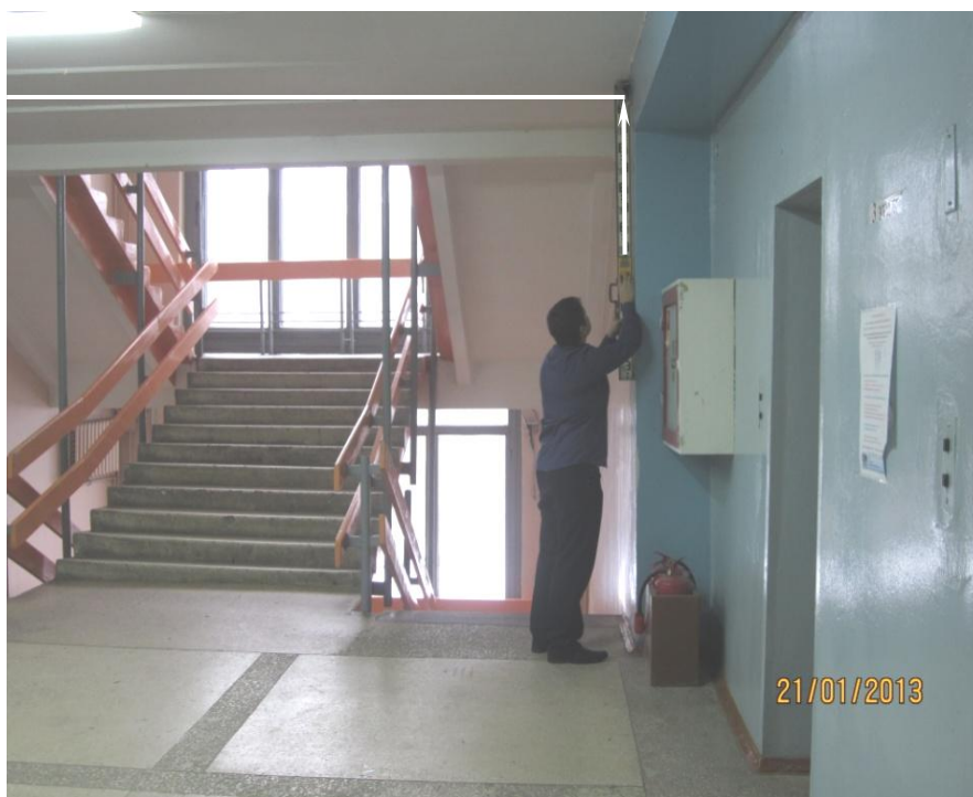
Рис. 5. Пример использования ЛЗУ для измерения труднодоступного расстояния
