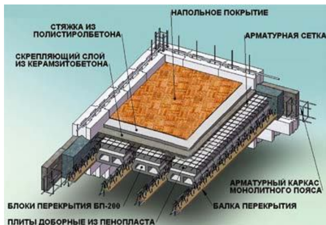
Рис. 5. Схема раскладки элементов несъемной опалубки Teriva
