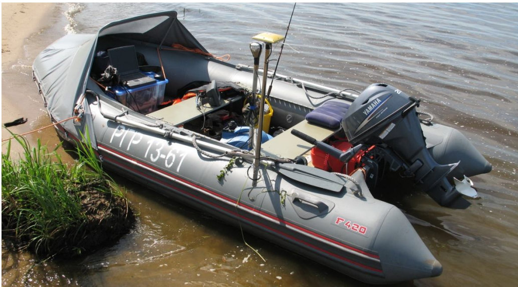
Рис. 1. Маломерное судно РГР 13-61 с установленным промерным комплексом ННГАСУ
