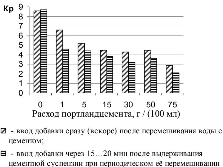
Рис. 2. График зависимости кратности пены от расхода портландцемента при концентрации раствора добавки SDO-LT 1,35 %
