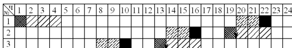
Рис.2. Циклограмма работы сушильных камер
