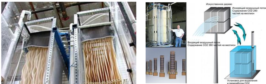
Рис.2. Модель искусственного дерева (справа) и фотография опытного образца (слева)
