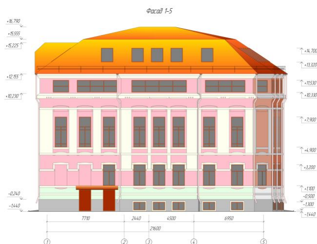
Рис. 1 Фасад в осях 1-5
