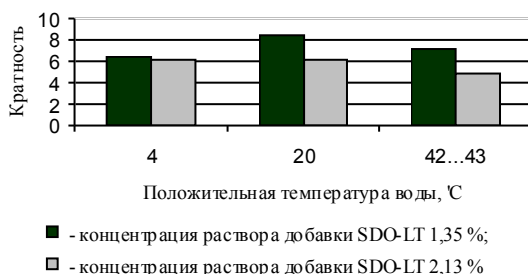
Рис. 3. Влияние температуры воды на кратность пены
