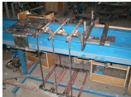
Рис. 4. Лабораторная установка для испытаний сжато-изгибаемых элементов.
