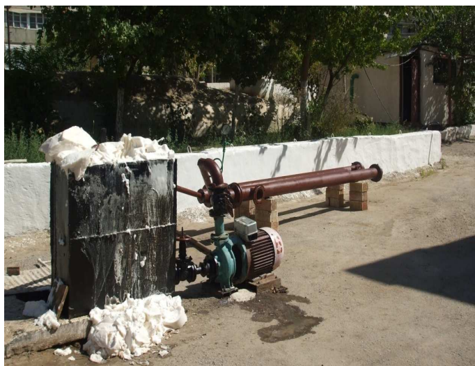
Рисунок 2 - Состояние экспериментально-испытательной установки и образование пены во время очистки.
