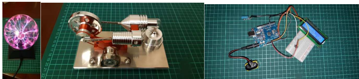
Рисунок 4 – Слева-направо: плазменная лампа, двигатель Стирлинга с генератором, метеостанция на базе модуля Arduino
