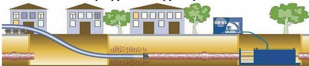
Рисунок 2 - Схема разрушения старой трубы с протягиванием полиэтиленовой
