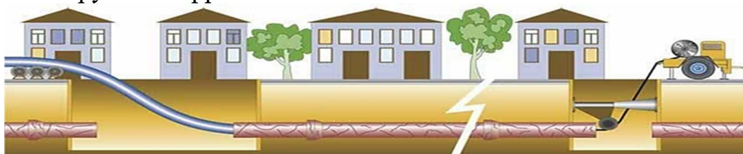
Рисунок 1 - Технология протаскивания полиэтиленовой трубы без разрушения
