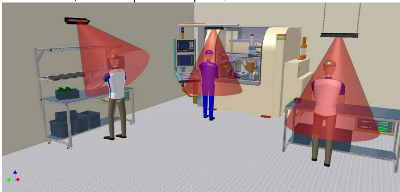
Рисунок 3 – Отопление рабочего места инфракрасными обогревателями
