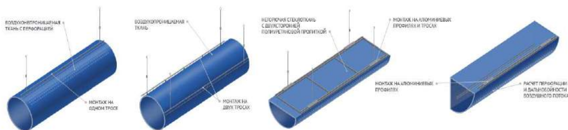
Рисунок 2 – Виды установки текстильных воздуховодов
