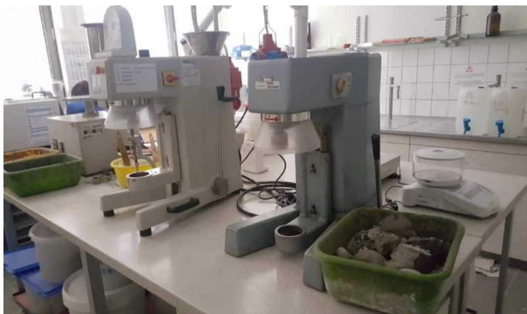
Рисунок 3- Оборудование для изготовления раствора
