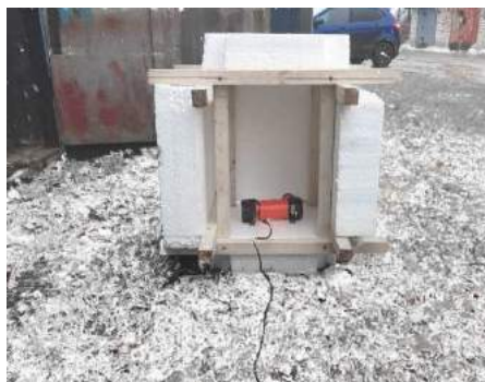
Рисунок 1. Проведение экспериментальной части-размещение в кубе нагревательного элемента
