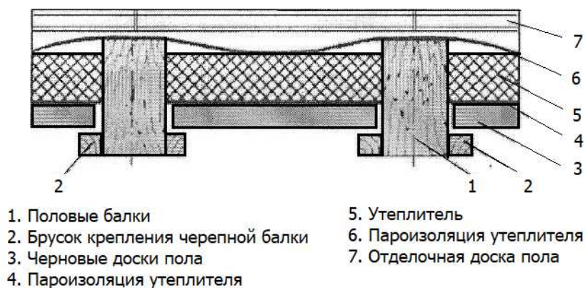
Рис.5. Утепление чердачной кровли
