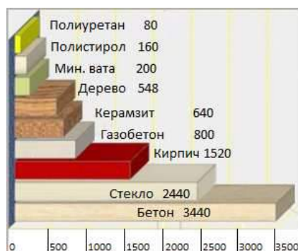
Рисунок 1 – Сопоставление тепло-изоляционных характеристик утеплителей с одиноковой теплопотерей
