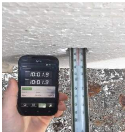
Рисунок 2. Проведение замеров температуры внутри куба и времени работы нагревательного элемента
