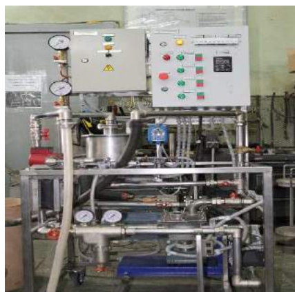
Рисунок 1 – Внешний вид комплексной установки по исследованию доочистки и обеззараживания воды
