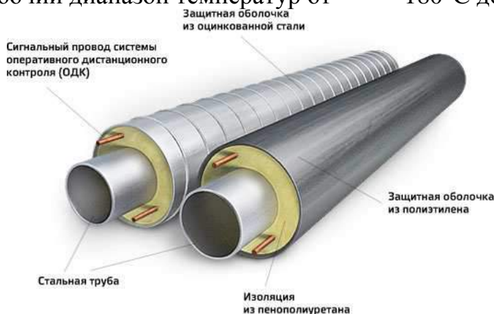
Рисунок 2 – Труба в ППУ изоляции
