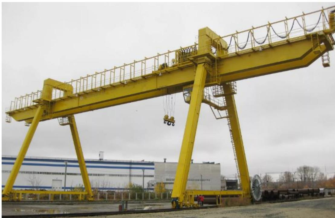
Рис. 4.7. Кран козловый бесконсольный К-202:  $H_{кр}$  (м) – высота подъёма крюка
