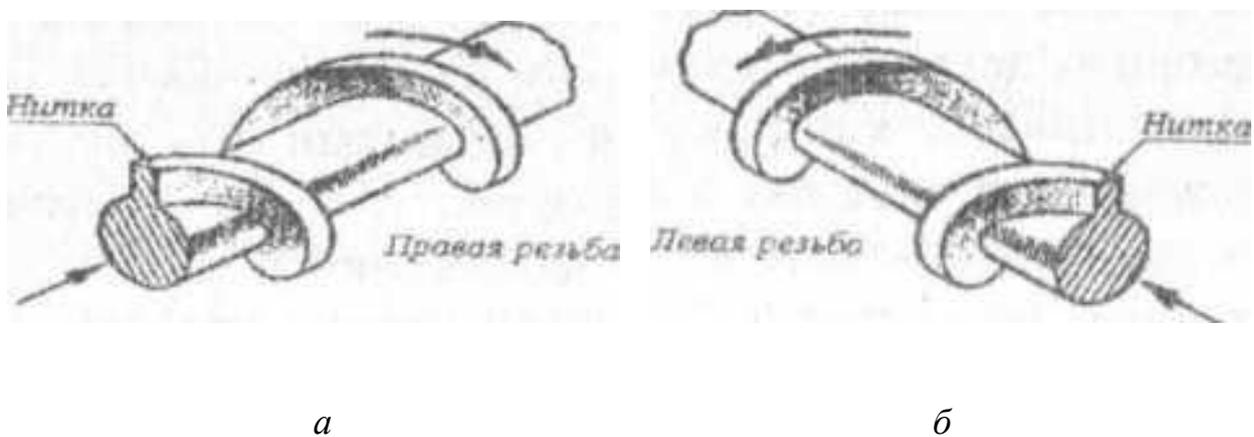
Рис. 1.2 Образование винтовых пиний: *а* - для правой резьбы; *б* - для левой резьбы
