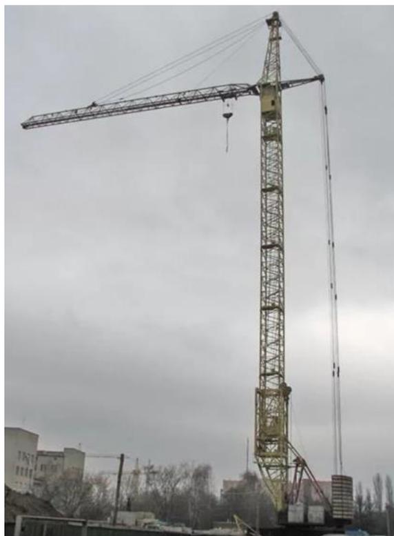
Рис. 4.2. Кран башенный с поворотной башней КБ-302А:  $L_{кр}$  – вылет крюка крана;  $H_{кр}$  – высота подъёма крюка;  $L_{кр}$  – вылет крюка кран
