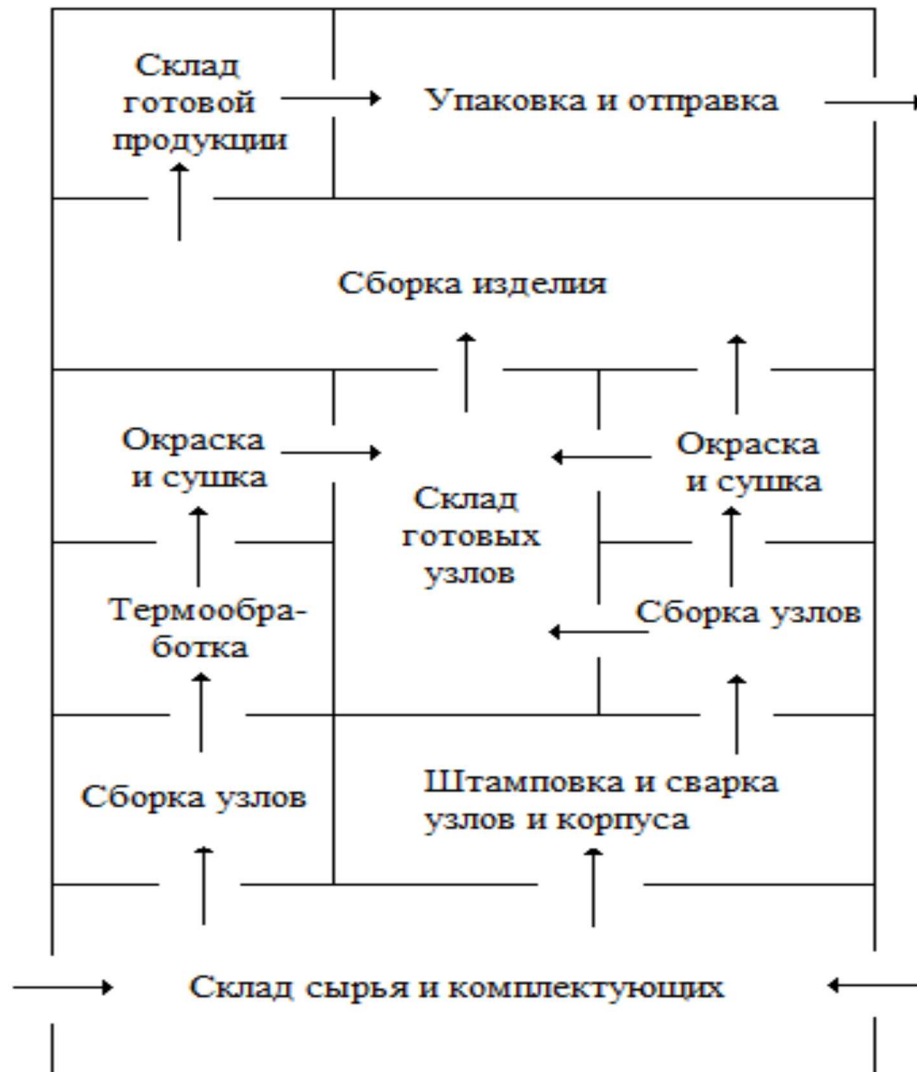
Рисунок 8 – Пример карты потоков сборочного производства
