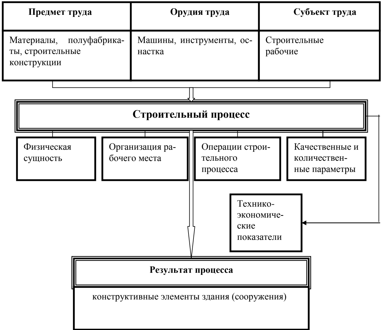
Рисунок 2.1 – Структурная схема строительного процесса
