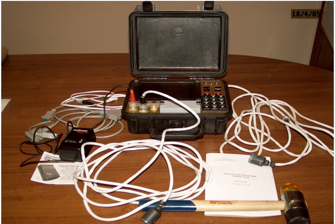
Рис. 2. Фото измерителя длины свай «ИДС» с комплектом сейсмоприемников.
