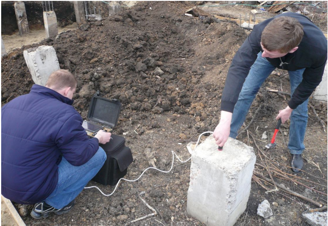
Рис. 11. Схема установки датчиков для проведения испытания свай при всестороннем доступе к конструкции
