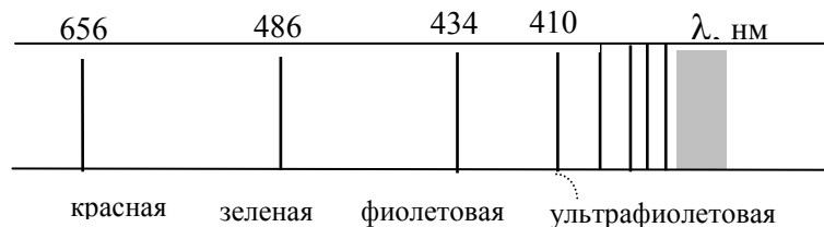
Рис. 5. Спектральная серия Бальмера в спектре атома водорода
