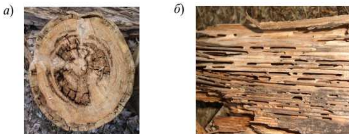
Рис. 25. Недопустимые пороки древесины: а – гниль, б – червотчины.
