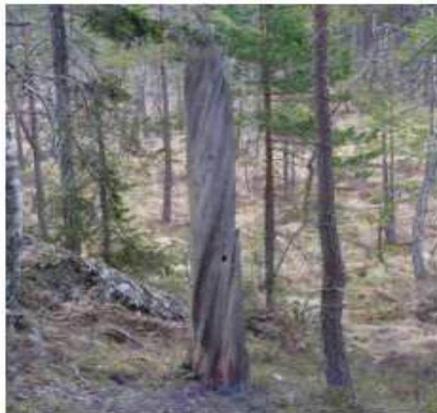
Рис. 28. Пороки древесины – тангентальный наклон волокон (косослой)
